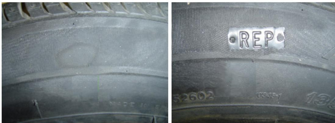
Mise en place d'un emplâtre à l'intérieur et d'un bouchon de gomme à l'extérieur. Vulcanisation à chaud.
