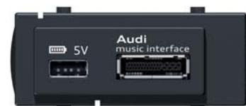
Bloc de connexion USB-Charge et AMI
