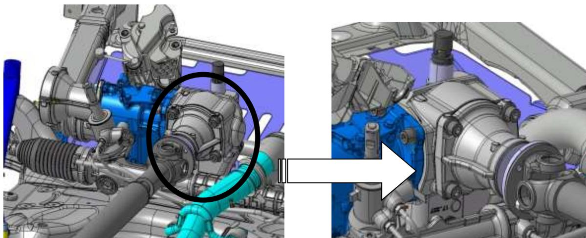
Ensemble mécanique transmettant le couple moteur à la transmission longitudinale par l'intermédiaire d'un renvoi d'angle.
