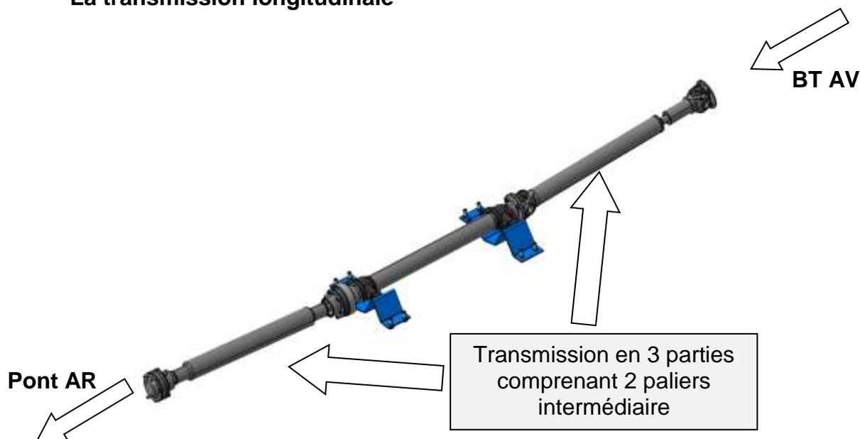
Elément mécanique transmettant le couple moteur aux roues arrière par l'intermédiaire d'un viscocoupleur.
