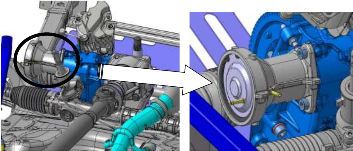
Ensemble mécanique permettant le passage de 2 à 4 roues motrices et inversement grâce à la commande présente sur la planche de bord.
