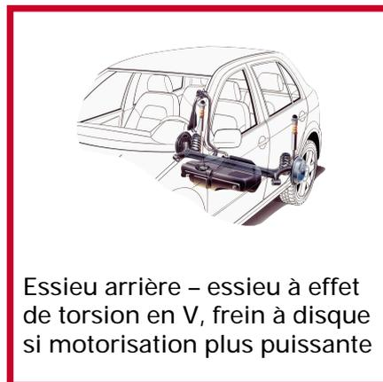
Essieu arrière – essieu à effet de torsion en V, frein à disque si motorisation plus puissante
