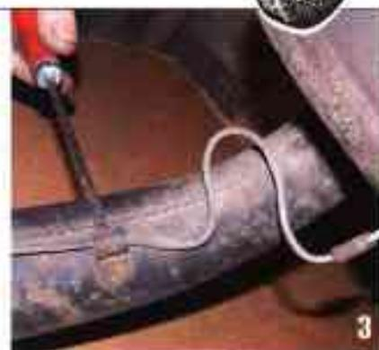
Soulevez les deux petites pattes soudées sur le bras avec un tournevis plat pour dégager le tube de frein du bras.
