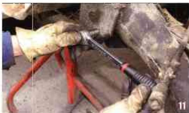
Attaquez le support d'amortisseur avant qui a aussi comme fonction de boucher l'entrée de l'essieu. Dévissez les trois vis avec la clé à cliquet et douille de 14. Comme vous le verrez sur la photo suivante, une fois libéré, laissez-le pendre à terre car vous ne démontez pas l'amortisseur.
