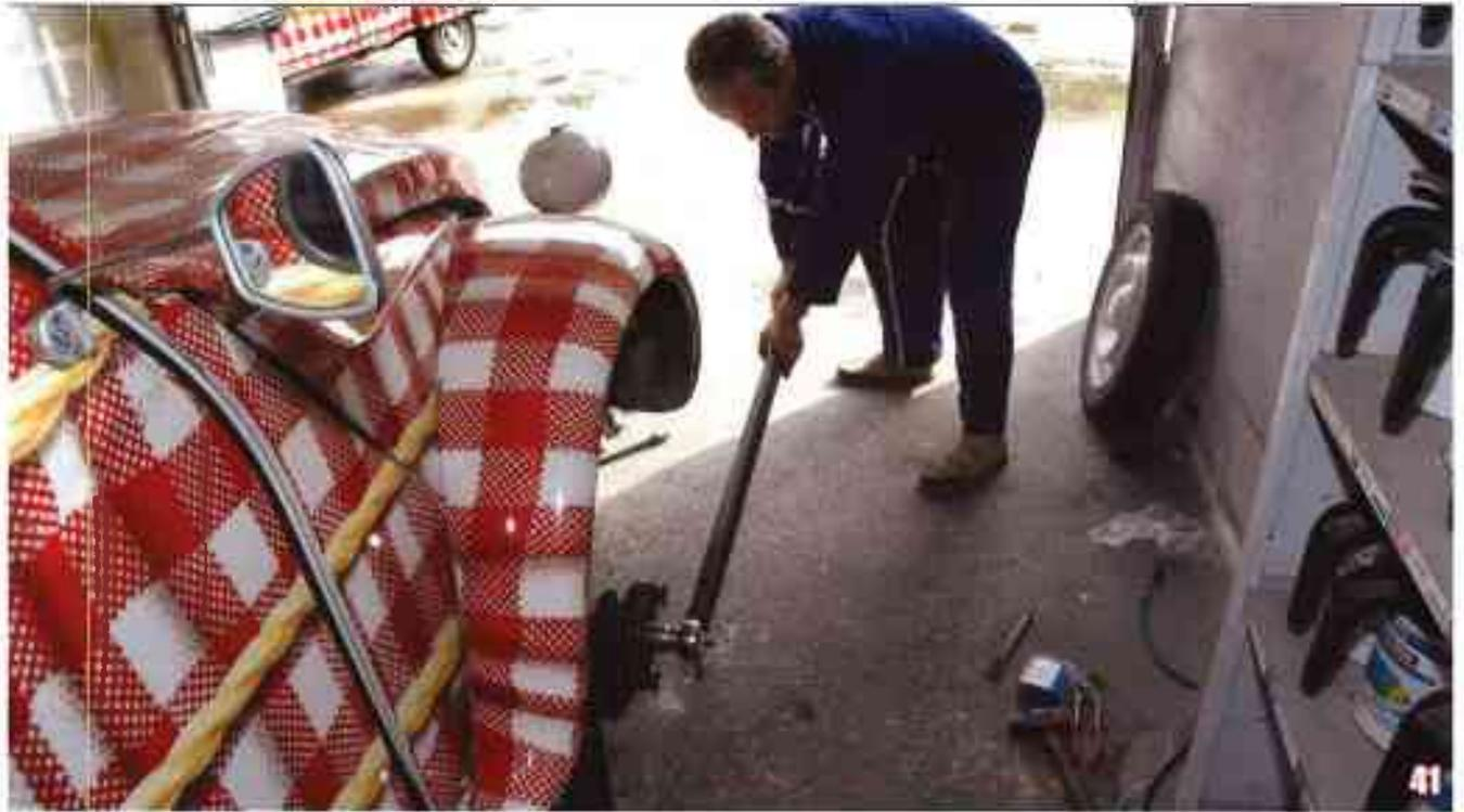
Serrez ensuite l'écrou de cardan avec le tube (si vous avez une clé dynamométrique de camion, sachez que le serrage est entre 35 et 40 kg). Vérifiez à la fin que vous êtes bien dans un trou entre deux créneaux de l'écrou pour pouvoir passer la goupille.
