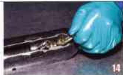
Mettez vos gants de Fantômas et déplacez la crémaillère (D) dans la position de la photo, en butée à l'opposé des deux trous (H) de la photo 11. Repoussez le siège (7) à l'aide de la rotule (B). Dégagez la rotule (B) du tube de crémaillère (C).
