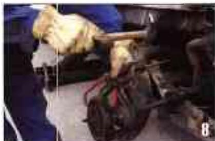
Vous allez désaccoupler à présent le levier de pivot du pivot proprement dit. Commencez par défreiner les deux vis en rabattant les arrêteurs vers l'extérieur au burin et marteau. Nous vous conseillons vivement de les changer à chaque intervention.
