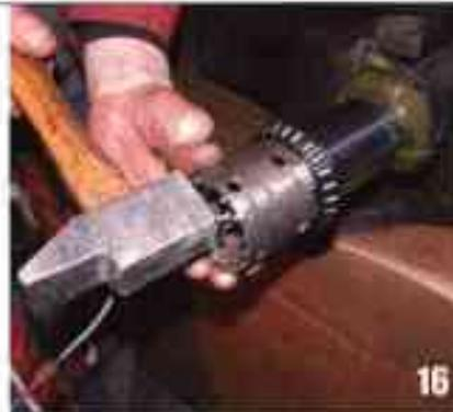
16 Mettez le roulement neuf en l'enfonçant comme ici. Attention, le roulement a lui aussi un sens de montage : la plus grosse extrémité du cône vers la fixation (voir photo).
