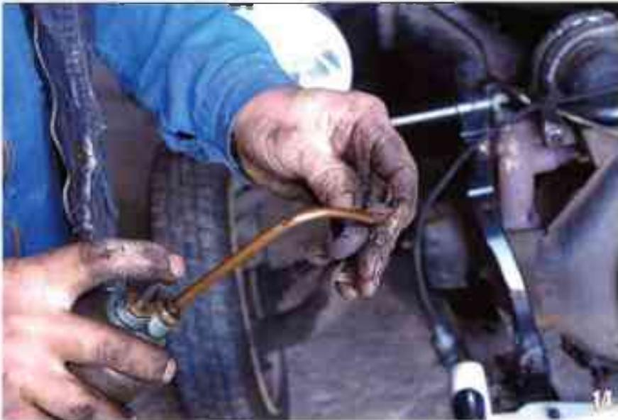
**Profitez de ce démontage pour nettoyer et déviller les vis des colliers de serrage. Le remontage en sera grandement facilité. À noter qu'il est recommandé de monter des colliers et vis neufs, ce qui évite de réutiliser des vis parfois fragilisées par la corrosion, le temps et le chaleur.**
