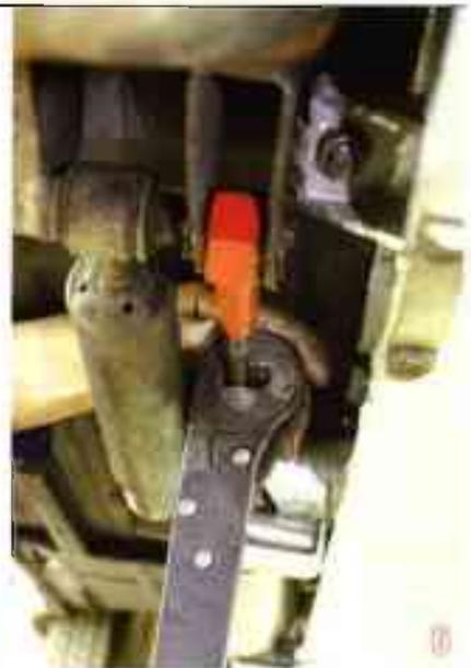
Notre clé à tuyauter en place. On le voit, l'amortisseur gêne le débâtement, aussi nous vous conseillons de le dégager en dévissant une fixation sur les deux pour libérer la course de la clé. Attention, l'écrou d'axe de fixation d'amortisseur ne doit être serré que lorsque les hauteurs sont réglées et la voiture reposée sur le sol, sinon vous pourriez détériorer les Silentbloc.
