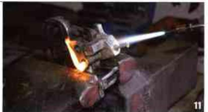
Le petit joint tubique en caoutchouc va fondre et brûler.
