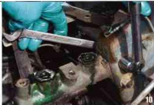
Avec deux clés de 14, au choix, dévissez les deux écrous des vis qui maintiennent le maître-cylindre sur le pédalier et sur le tablier.
