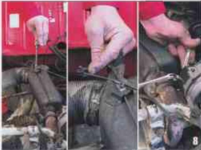
Ce n'est pas une obligation, mais retirer les boîtes de chauffage permet un accès encore plus aisé. Pour cela, utilisez une clé de pipe de 8 pour dégager la gaine du câble (photo de gauche). Vous déclipsez l'extrémité du câble (photo de milieu). Vous desserrez les colliers d'échappement avec deux clés de 11 mm aux deux extrémités de la boîte (photo de droite).
