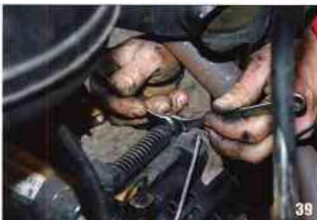
39 Dévissez le câble de frein à main (un écrou et un contre-écrou, clé de 11). Sortez le câble. Répétez l'opération de l'autre côté.
