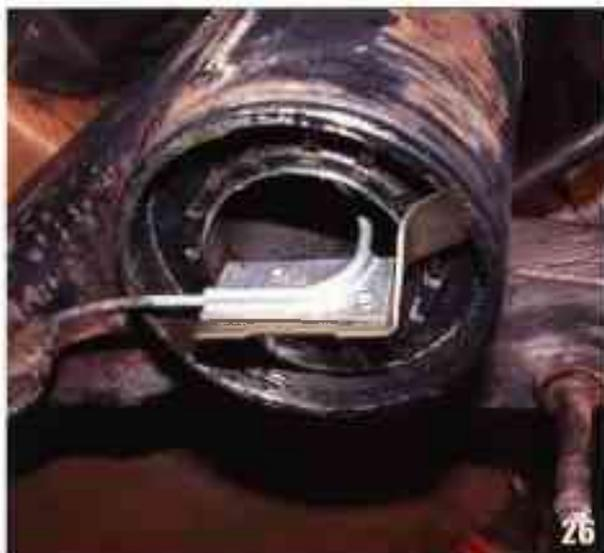
Repositionnez la placine métallique dans ses encoches et repliez, par la force des choses, le tuyau de frein comme il se doit.
