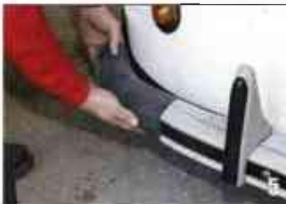
Mettez des protections caoutchouc (chambre à air découpée) aux extrémités du pare-chocs avant.
