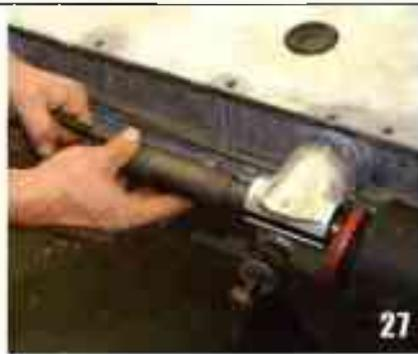
27 Enquillez sur l'avant l'embout de réglage dans la tige filetée, puis dans le logement du châssis.
