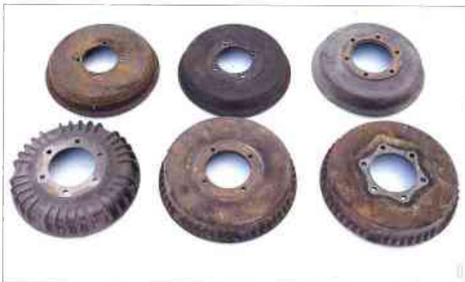
Au fil des ans il y eut plusieurs modèles de tambours, mais de deux diamètres seulement : 200 et 220 mm. L'Ami 6 fut la première à avoir des tambours surdimensionnés puis la Fourgonnette AK 400 et enfin la 2 CV. Sur cette photo, les principaux tambours de la 2 CV.
