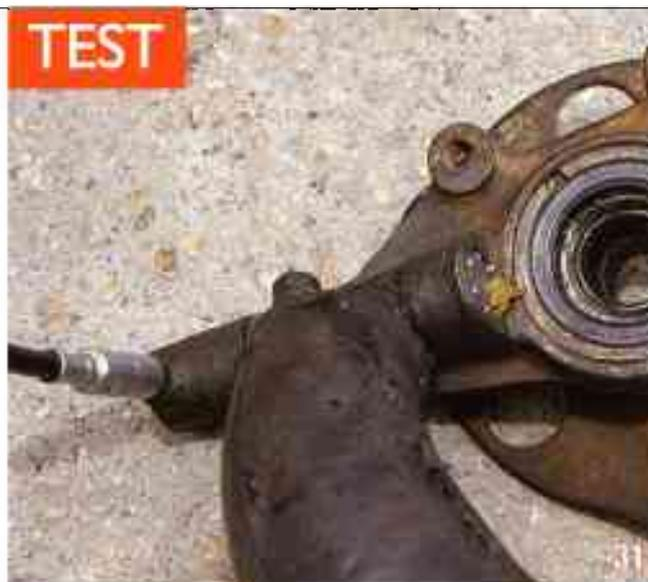
La pompe à graisse sera impitoyable et si vous avez une fuite au bouchon expansible (ce qui est notre cas), il faudra peaufiner le sertissage. Attention, pendant le graissage, vous devez manœuvrer le pivot sur le bras !
