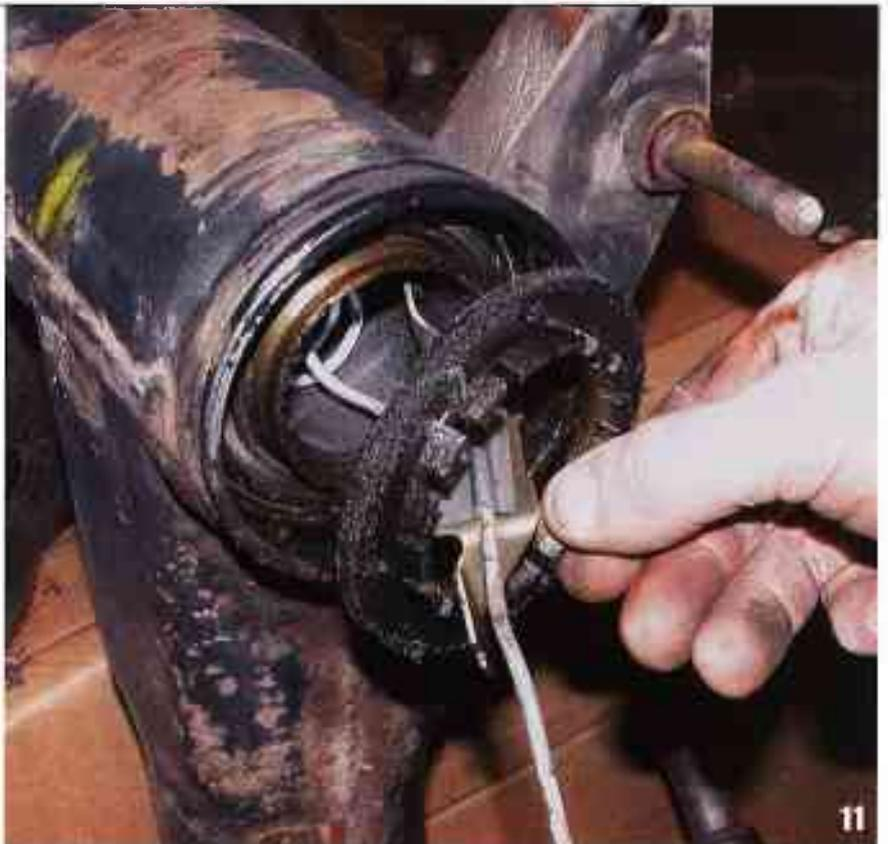
Vous dégagé l'écrou à encoches surmonté du joint de roulement (en feutre ou SPI en caoutchouc selon modèle).
