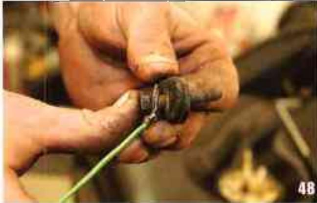
N'oubliez pas sur l'une des vis de placer le fil de masse de la sonde du réservoir.
