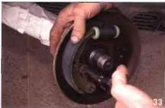
Remplacez la mâchoire. Verrouillez-la avec le petit ressort et sa coupelle en utilisant la pince à clips.
