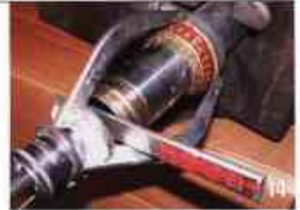
14 Avec un arrache-moyeu 3 points, vous sortez le roulement. Il est possible de positionner les doigts de l'arrache-moyeu directement sur la feutrine ou le joint SPI caoutchouc (qui sera à changer) se trouvant derrière le roulement.
