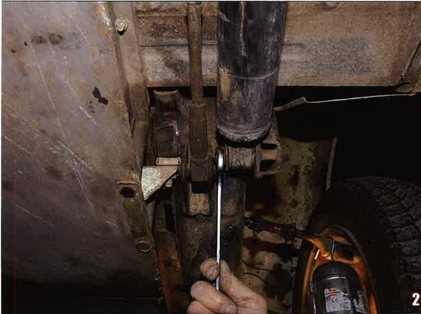
La voiture sur un pont (c'est le mieux) ou sur cric, desserrez l'écrou de fixation de l'avant de l'amortisseur. Vous le sortirez plus tard.
