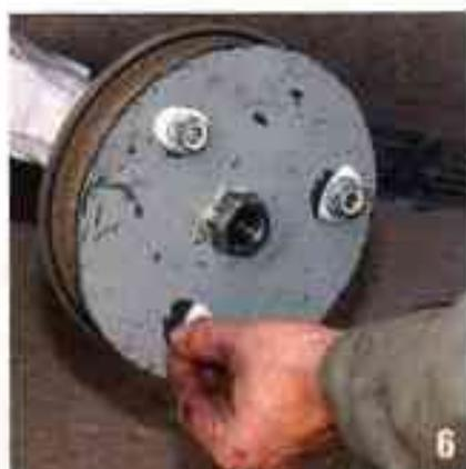
Nous mettons en place notre outil et nous resserrons les trois boulons des tocs de roues.
