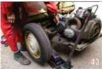
Mettez la roue sur cric pour faire tourner le tambour. Régler les excentriques l'un après l'autre jusqu'au léchage (quand on entend que ça frotte légèrement).
