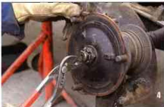
4 Extrayez la goupille d'arrêt d'écrou de cardan avec une pince crocodile.
