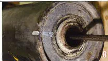
A l'aide d'une pointe à tracer, de peinture ou d'un feutre, repérez la position de l'embout de carter pour le repositionner à l'identique au remontage.
