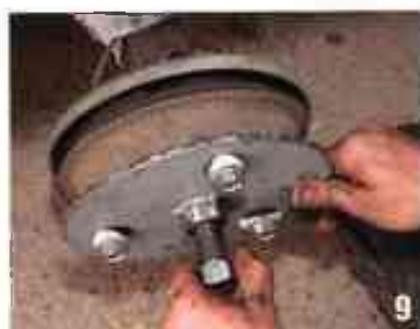
Au centre du plateau, dans le pas de vis de l'écrou de 32, vous vissez une grosse vis qui va permettre d'extraire le tambour au fur et à mesure du vissage.
