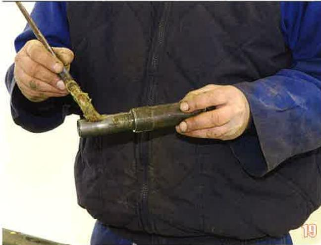
Graissez à la graisse marine les embouts de réglage.
