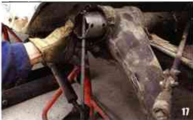
Dévissez l'écrou crénelé avec la clé spéciale, mais, si vous n'en avez pas, faites-le au chasse-goupille et au marteau en changeant de dent régulièrement pour éviter de massacrer l'écrou crénelé.
