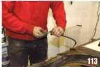
Retirez la protection caoutchouc de la Durit d'essence à l'arrière car sinon le tuyau ne passera pas dans le trou du châssis (avec passe-fils que vous devrez récupérer).
