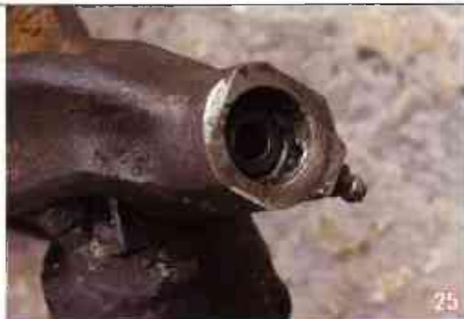
Retournez le pivot, vous constatez que l'axe n'obstrue pas l'orifice de graissage, tout est OK. Manœuvrez le pivot sur le bras, vous ne devrez trouver aucun point dur lors de cette manipulation. Si c'est le cas, il faudra tout redémonter et constater les dégâts car vous aurez foiré quelque chose inévitablement. Recommencez ! Si ce n'est pas le cas, bravo !
