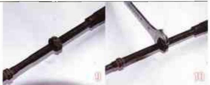
Une solution astucieuse pour le remontage : serrez deux écrou et contre-écrou de Ø 11 à pas de 100 qui, le jour où vous voudrez re-régler votre suspension, vous permettront de le faire avec une simple clé plate de 19 (attention, l'écrou de Ø 11 à pas de 100 existe aussi en version pour clé de 17 ou plus grand que 19).
