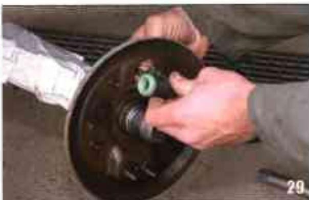
Nous procédons au remontage. Vissez le tuyau sur le cylindre sans avoir encore remonté le cylindre. Vissez le cylindre sur le plateau avec des vis neuves car les anciennes sont souvent très attraquées.
