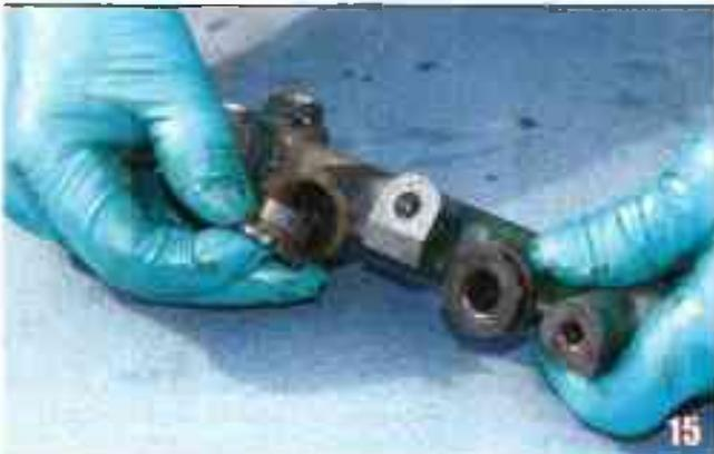
Retirez les deux caoutchoucs qui font l'étanchéité entre le bocal et le maître-cylindre.
