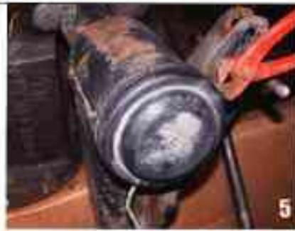
Coupez le "Ligarex" (le lien métallique qui enserre le bouchon de moyeu en plastique de bout d'essieu, dit aussi "pare-poussière") avec une pince coupante.
