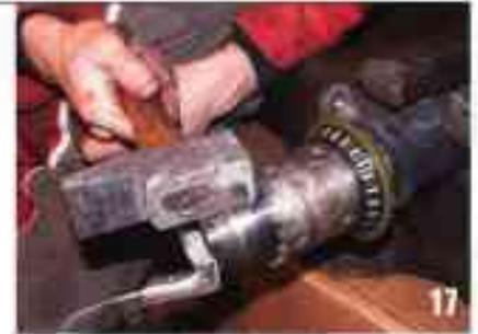
17 Vous devez aider le roulement à passer la portée du roulement extérieur avec la clé à encoches ou mieux encore (car ça peut abîmer la clé) avec un bout de tube à la bonne cote. Vous devez "tapoter" sur la bague intérieure du roulement pour le repousser à fond et non pas sur les rouleaux.
