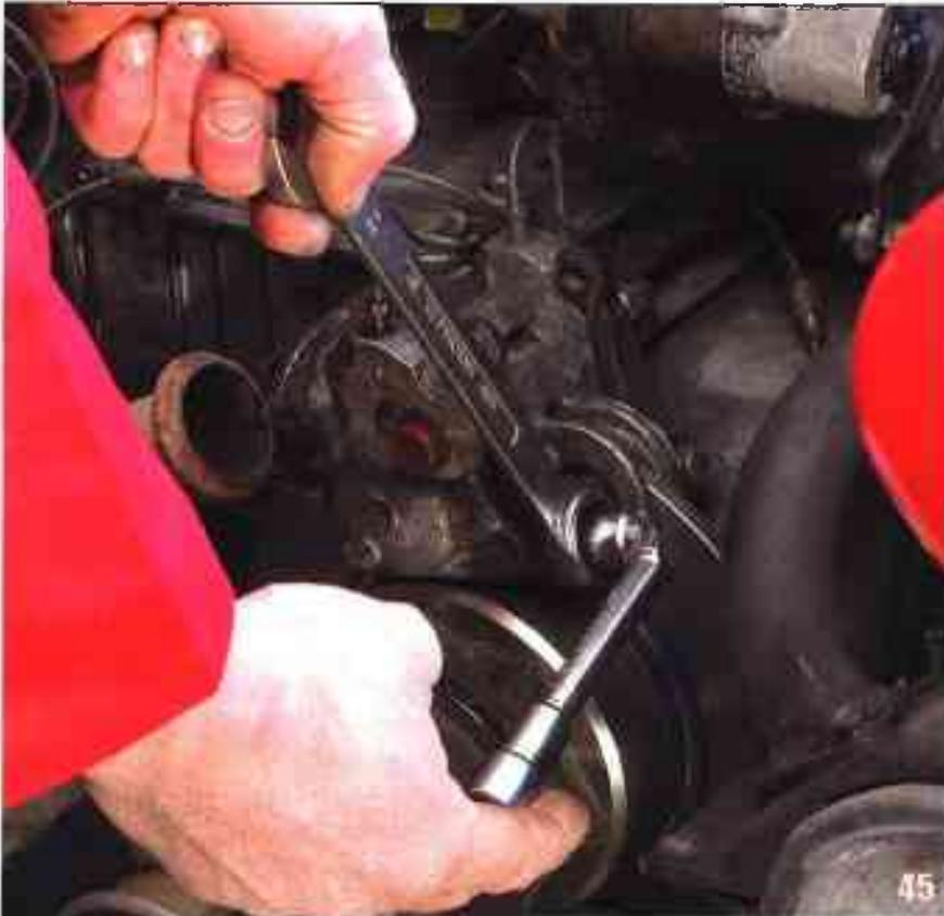
En maintenant l'excentrique en place avec une clé à œil de 21 mm, vous serrez à la clé de 14 la vis de fixation du levier de sécurité de frein de secours. Quand vous tirerez le frein à main, c'est ce levier (un de chaque côté) qui poussera la plaquette contre le disque.
