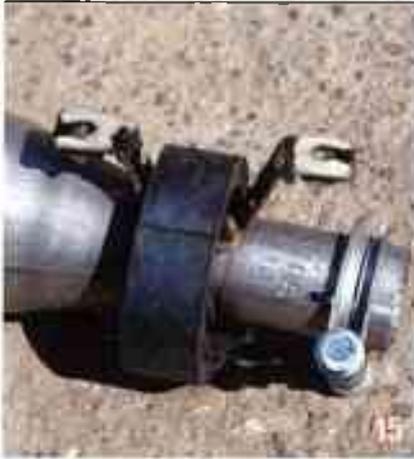
Vous installez les 2 pattes de fixation anciennes qui vont servir à fixer le pot à la caisse. Celle qui est la plus évasée va à l'avant du pot secondaire et l'autre à l'arrière.
