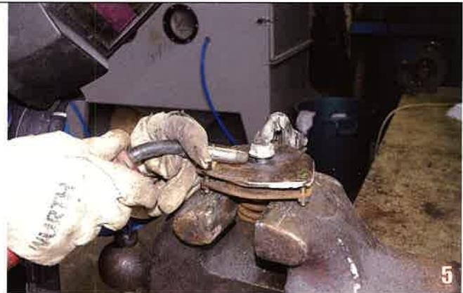
Vissez la pièce et le frotteur à l'aide de trois boulons de 7 mm. Coupez une vis de 14 mm et maintenez-la en appui au centre de la pièce par une pince-étau. Soudez-la au Mig, bien au centre, c'est important.
