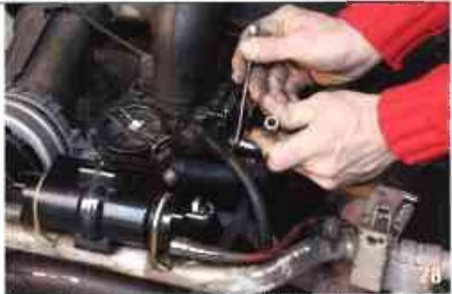
Dévissez l'écrou du câble de starter. Clé de 8 plate pour bloquer et clé à pipe de 8 pour desserrer — si vous ne faites pas comme ça vous allez tordre le câble.
