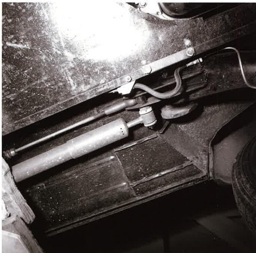
Septembre 1965, l'une des premières 2 CV équipées d'amortisseurs hydrauliques. Notez le sens du montage car c'est le bon !
