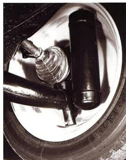
Le batteur, sur 2 CV d'avant septembre 1965, il y en a un sur chaque roue.
