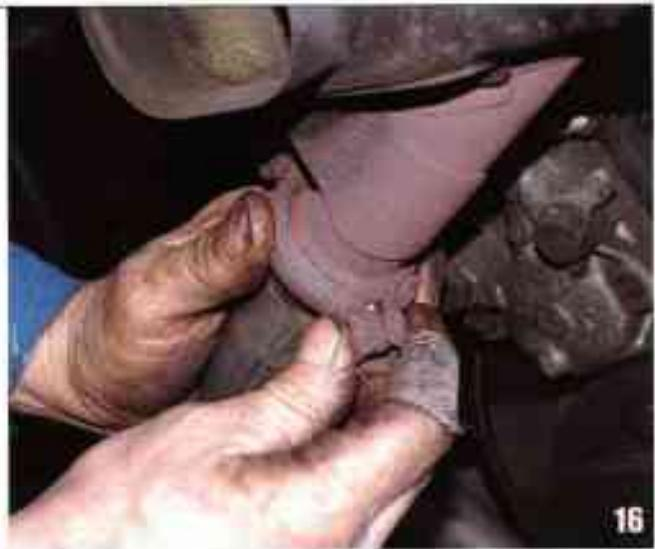
Côté droit, placez un collier de serrage entre la boîte à chauffage et la bête à cornes.
