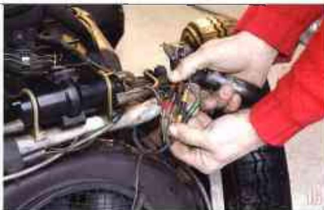
16 Déconnectez côté gauche tous les fils électriques du faisceau compartiment moteur. Pas de panique, tous les fils sont repérés par couleur.
