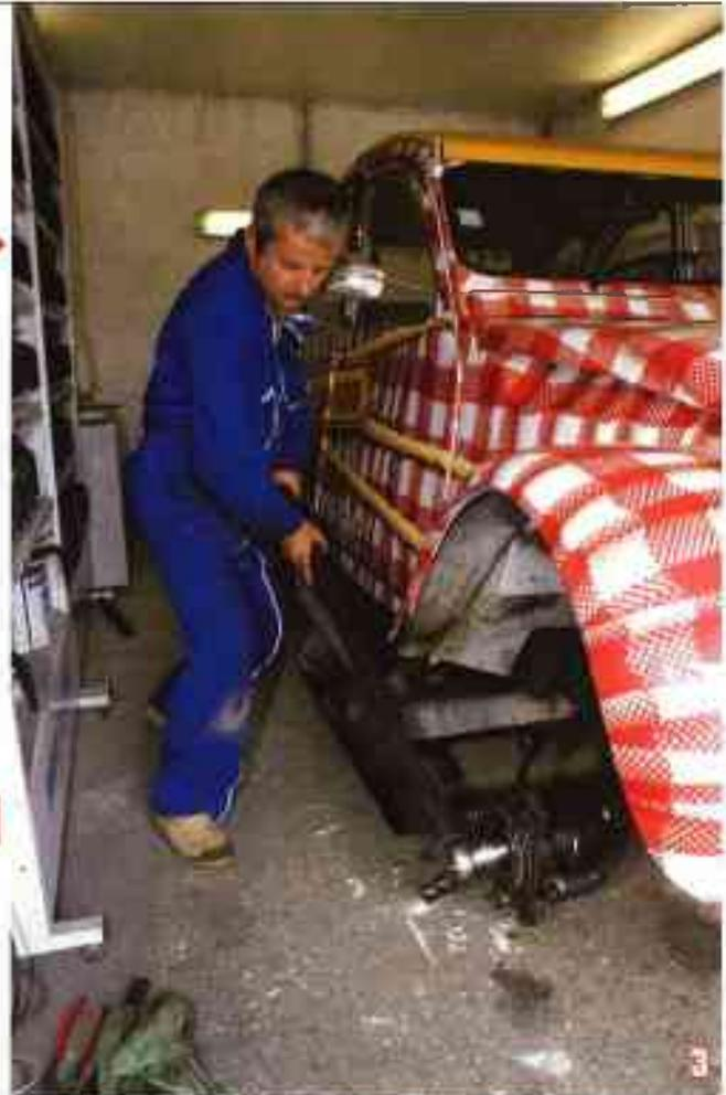
Placez la douille de 32 sur l'écrou crénelé et glissez dans la grosse clé à cliquet un tuse pour faire levier. Débloquez l'écrou.
