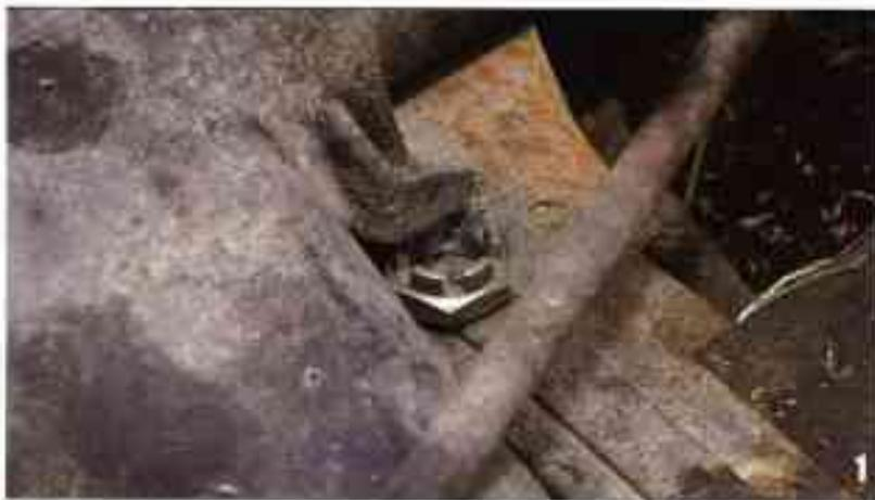
Placez une cale de 2 cm environ sous la patte du bras de suspension (ici un gros écrou). Cette cale évitera, quand la voiture sera levée sur cric, que le bras ne retombe sur le châssis, que le cardan ne descende également en frottant sur le châssis et, cerise sur le Mac Do, de cisailer le soufflet de cardan intermédiaire.
