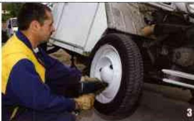
3 Démontez la roue à l'aide d'une croix ou d'un pistolet pneumatique pour les nantis. Si vous utilisez une croix, pensez à débloquer les roues avant de lever le véhicule.
