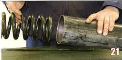
Enfilez le ressort dans le carter — attention à l'inclinaison des spires, ici nous traitons l'avant, donc le sens d'enroulement des spires est donc à gauche. Pour ne pas vous tromper, regardez le dessin page 27, l'inclinaison des spires des deux ressorts une fois en place forme comme un «V».
