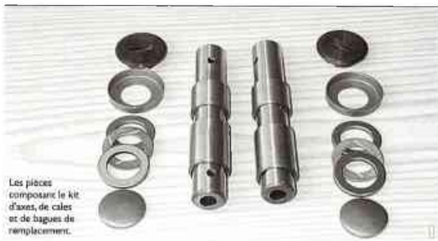
Les pièces composant le kit d'axes, de cales et de bagues de remplacement.
