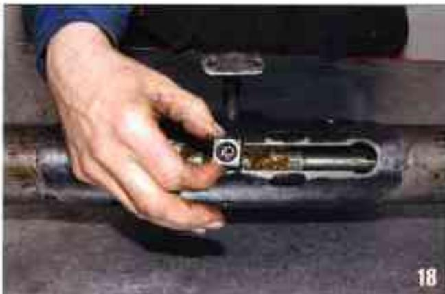
Positionnez les dés sur les queues de rotules. Remettez en place le cache-mobile préalablement graissé, puis la glissière. Posez les arrêtoirs et les vis. La crémaillère doit se déplacer librement. Freinez les vis par les arrêtoirs.
