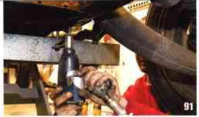
91 Dévissez les 4 vis de fixation d'essieu avant (2 de chaque côté). Clé de 17. Enlevez l'essieu complet.
