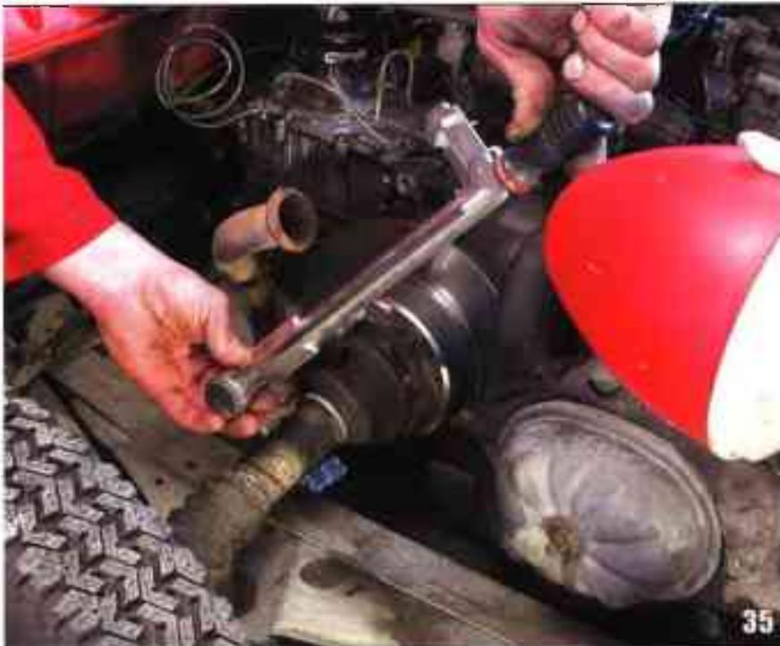
Vous remettez le cardan en place, vous vissez les 6 vis et vous finissez à la clé dynamométrique, réglage de force 5 à 6 kg.
