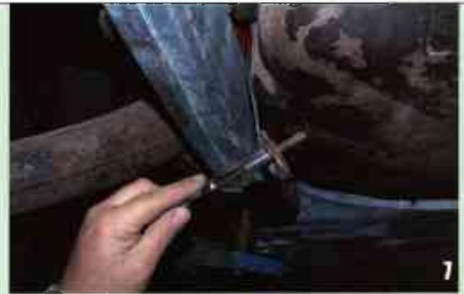
Dévissez une par une les 4 vis qui maintiennent le réservoir en place. Commencez par les 2 de côté. Vous allez dévisser avec l'une des vis un fil de masse qu'il ne faudra pas oublier de refixer lors du remontage. (Clé à cliquet avec rallonge et douille de 11.)
