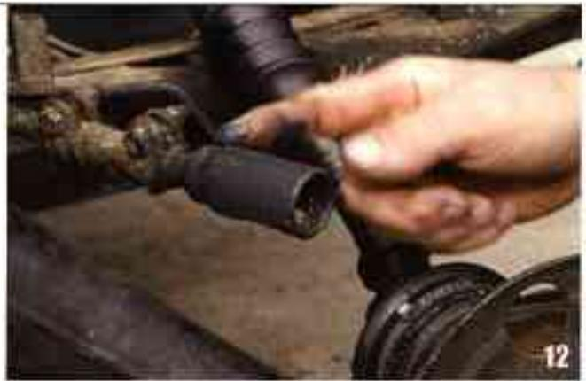
12 Graissez aussi bien l'intérieur que l'extérieur de l'embout. Remontez le ressort, puis un siège.
