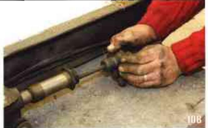
Sortez le tube et tirez à rebrousse-poil le soufflet pour le sortir du tirant.
