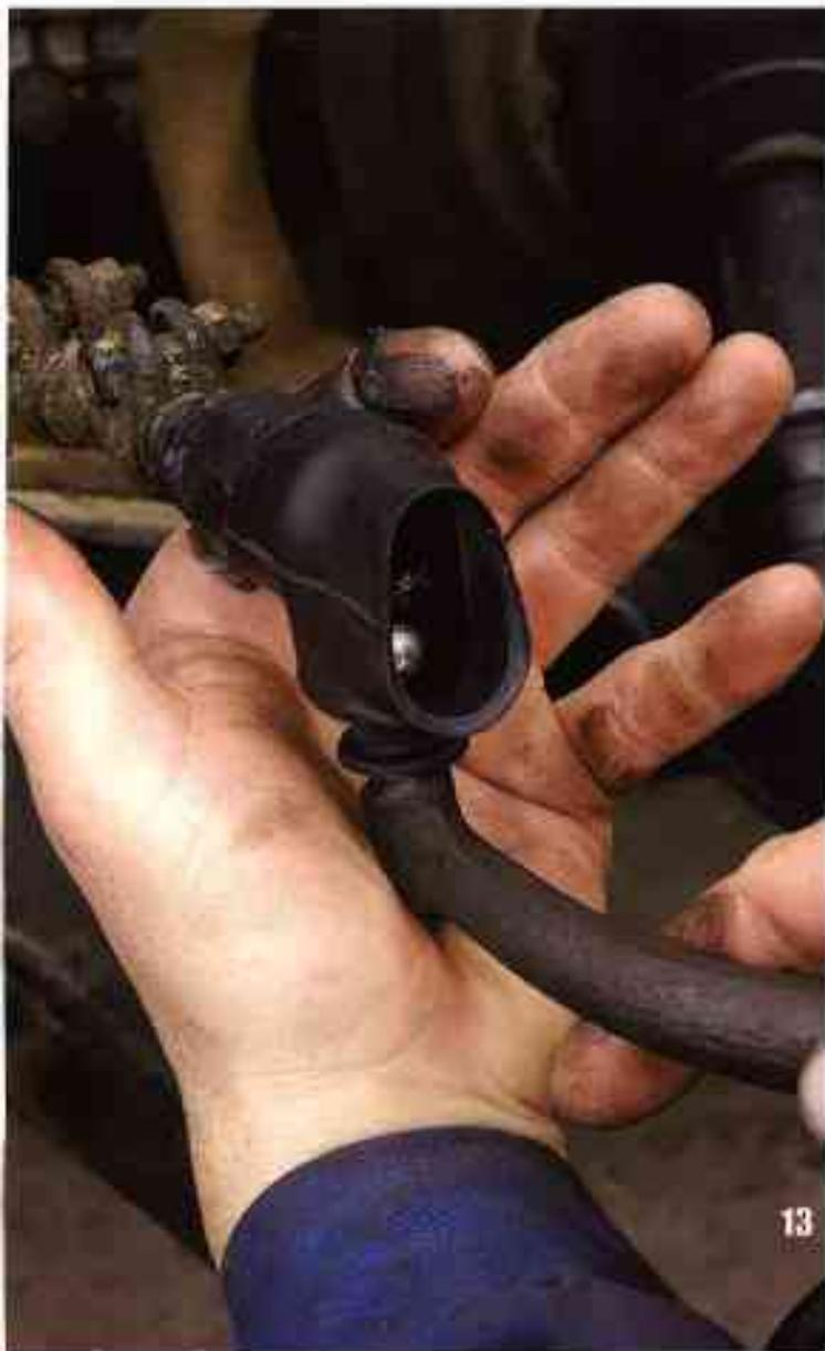
13 Enfilez le cache-poussière neuf sur l'embout, tout en tirant la rotule vers le bas de façon à la faire passer sous l'embout. Avancez l'ensemble en remettant les deux méplats en position d'entrée. Faites entrer la rotule par dessous et tournez-la de 1/4 de tour pour l'emprisonner. C'est quand même plus facile qu'un Rubik's cube, non ?
