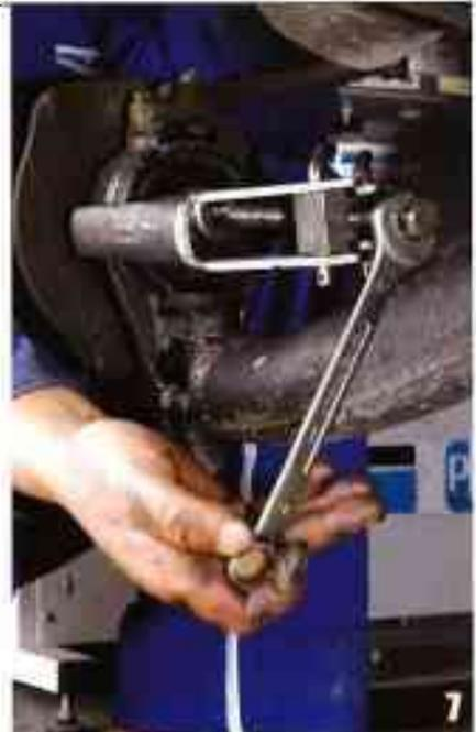
Vissez à la clé de 17 (suivant modèle d'arrache-moyeu).
