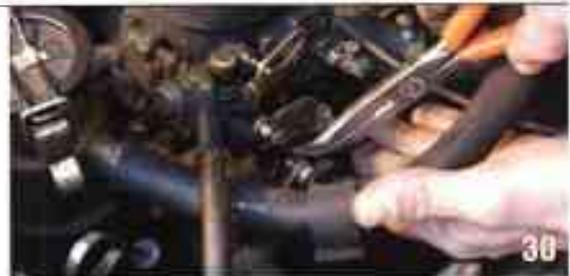
Avec une pince à bec, sortez la goupille de verrouillage de l'axe du câble d'accélérateur. Sortez l'axe. Tirez le câble. Remettez l'axe en place, puis la goupille (sur le câble ou sur le carbu, histoire de ne pas les perdre).
