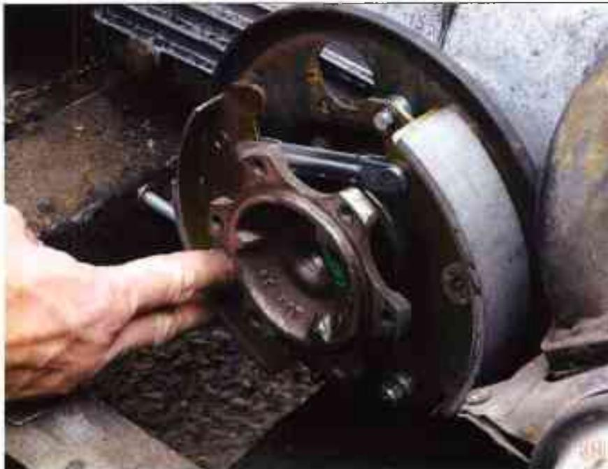
◀ Mettez la seconde partie de la mâchoire. Attachez la calotte en premier pour maintenir le segment avant, puis casez l'excentrique et vissez-le. Serrez normalement.
