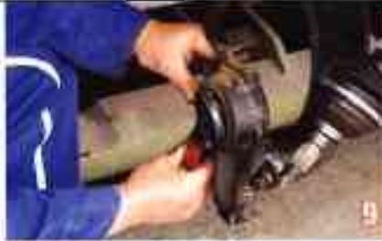
À l'aide d'un outil adapté, par exemple un burin large, sortez le joint spi côté roue. On le changera pour un neuf.
