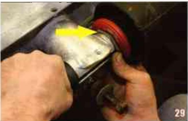
29 Tournez l'embout de réglage à la main pour le visser provisoirement sur l'écrou (flèche).
