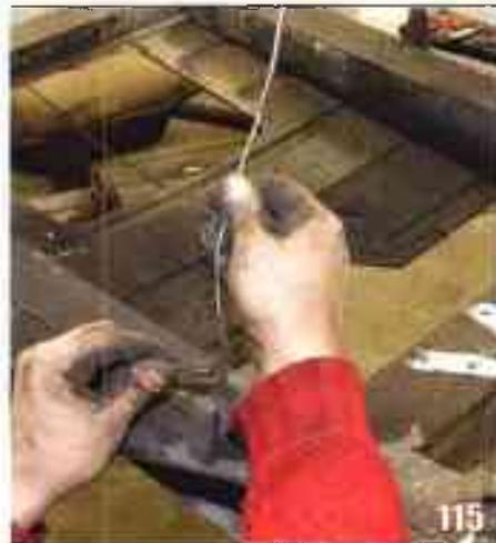
Retirez à présent le tuyau de frein lui aussi clipé le long du châssis. Détordez-le avec précaution pour pouvoir le sortir dans l'axe du châssis.
