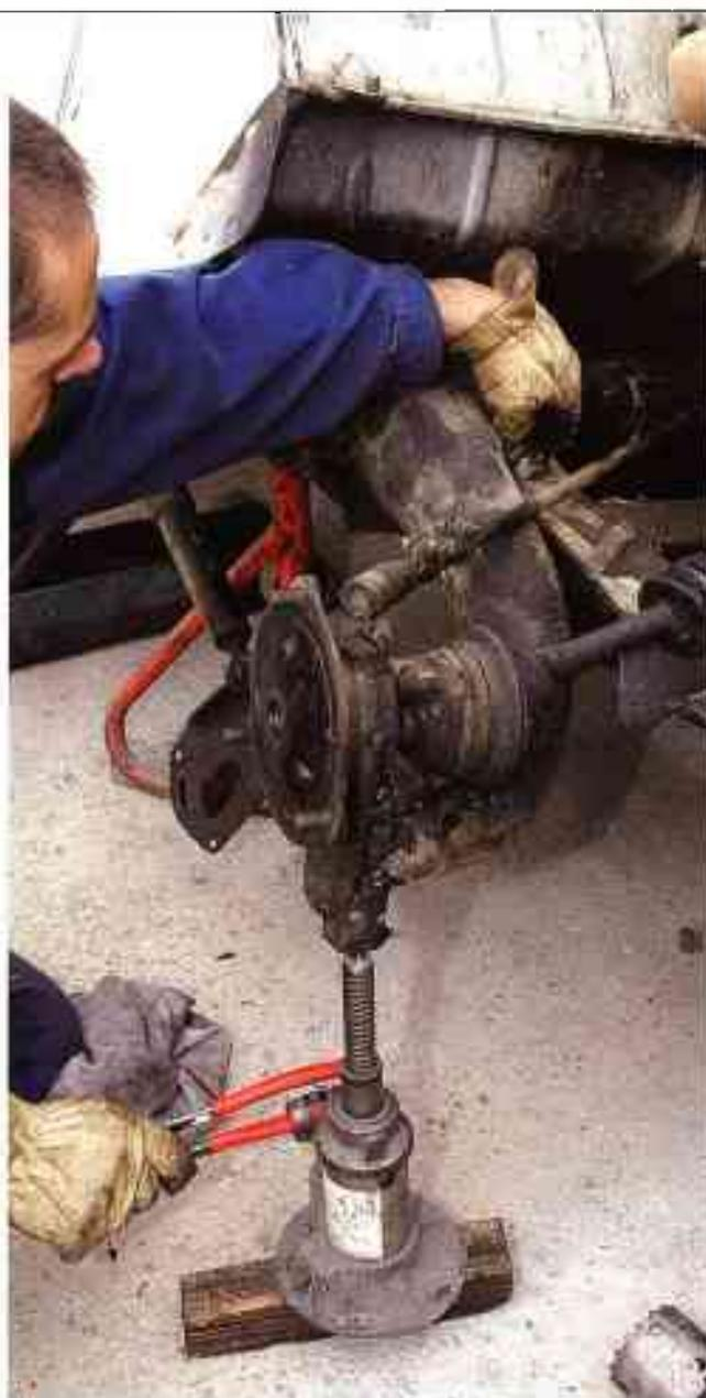
Mettez un cric sous le bras. Levez-le jusqu'à dégager la petite cale de la photo 1 que notre mécano retire ici, tout cela pour donner du mou au tirant de suspension (caché sur cette photo).
