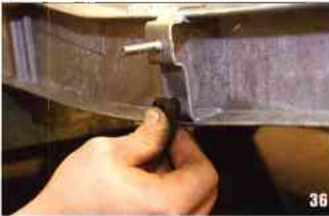
Sur l'arrière du châssis, là où se fixe le premier caoutchouc de maintien de l'échappement, placez dans son logement le petit tampon caoutchouc que vous aurez récupéré sur l'ancien châssis car, pour l'instant, il ne semble pas avoir été refabrique.
