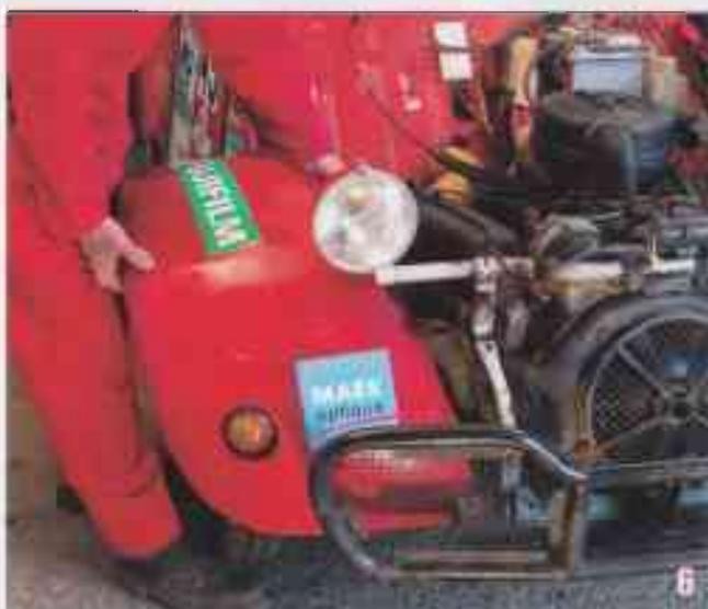
Avant de sortir l'aile sur une voiture d'origine, nous vous conseillons de mettre un morceau de vieille chambre à air sur les extrémités du pare-chocs pour protéger la peinture. Attention aussi à la potence de phares qui peut rayer l'aile, soyez vigilant. Les deux gaines latérales restent sur les boîtes de chauffage.
