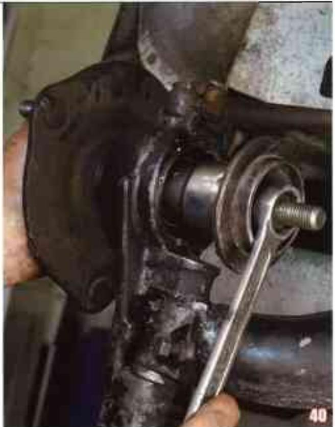
Rapprochez au mieux le moyeu avec l'outil-maison n° 3 (douille de 36 et second plateau en place) en serrant. Ensuite mettez en place le joint spi intérieur qui doit affleurer la bague écrou. Remettez le cardan en place. Serrez l'écrou de cardans à la main.
