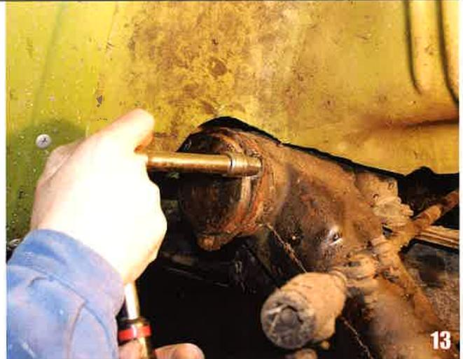
13 Dévissez le capuchon de protection maintenu par trois vis de 7. Clé à cliquet avec douille de 11.
