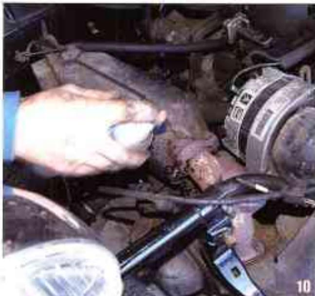
Si nécessaire, dégraissez le collier avant de la boîte à chauffage. Il nous faut trouver du jeu pour bouger la boîte à chauffage toujours sans rien démonter...
