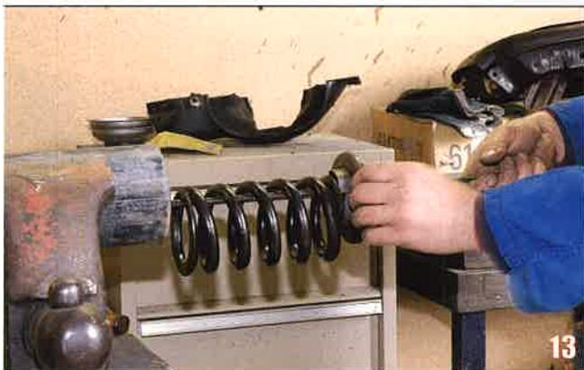
Ça y est enfin ! Voici le ressort à boudin à l'air libre... Dégagez l'ensemble comprenant le tirant, la coupelle de fermeture, le ressort de suspension et la coupelle de compression.
