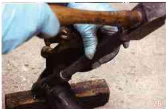
Au jet et au marteau, positionnez le bouchon expansible neuf. C'est une capsule d'étanchéité qui sert à retenir la graisse dans le corps du pivot.
