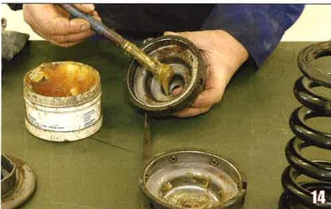
Bien enduire l'intérieur des coupelles de compression de graisse marine (elle est hautement collante !).
