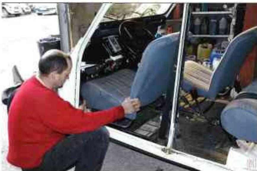
Avancez le siège à fond sur l'avant et sortez-le. Il existe selon modèle une goupille sur le rail entre siège qu'il faudra retirer.
