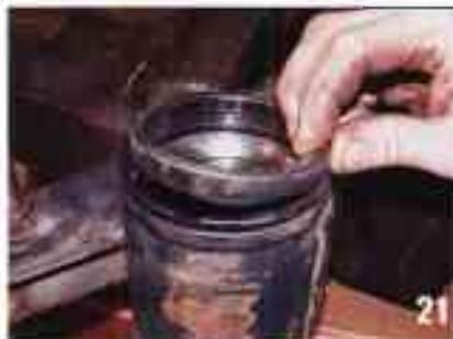
21 Mise en place de la nouvelle cage extérieure de roulement. Il y a une astuce de montage : on a meulé l'ancienne cage pour pousser la nouvelle dans son logement sans la mettre de travers.
