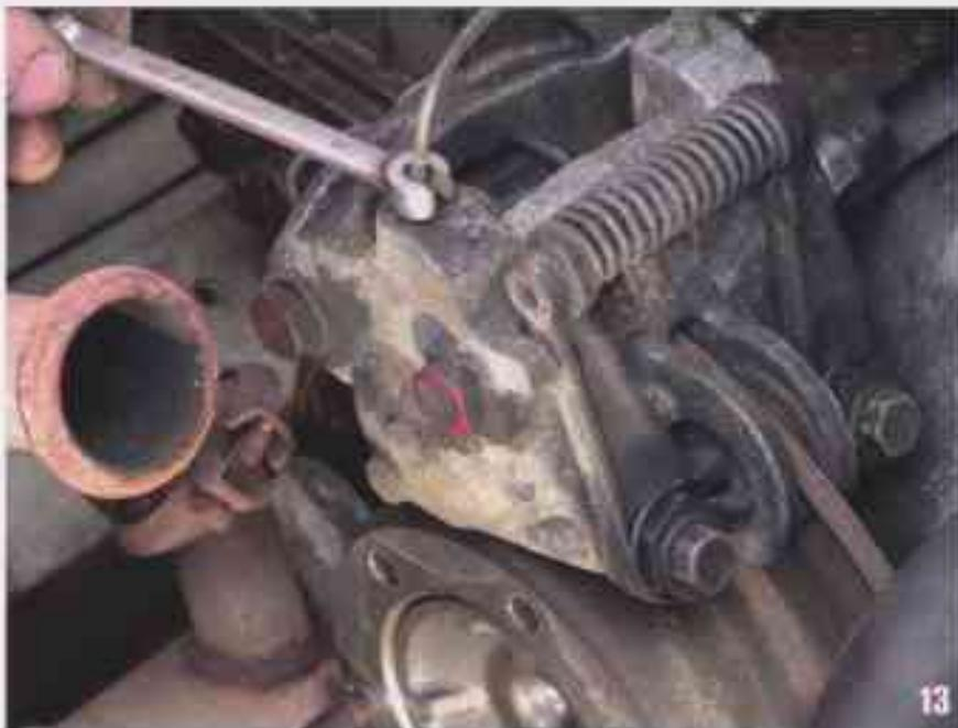
Avec la clé à tuyauter, vous démontez les tubes de frein. Sur le côté droit (vu dans le sens de la marche), débouchent deux tubes, celui où se trouve la clé reçoit le liquide depuis le maître-cylindre et l'autre renvoie le liquide sur l'étrier de gauche. Pour résumer : 1 tube à gauche, 2 tubes à droite à dévisser avec précaution.
