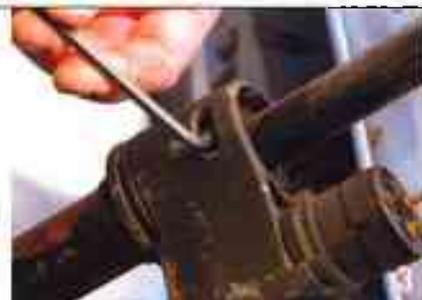
Avec une clé alène de 5, vous desserrez la 1<sup>re</sup> vis des demi-bagues de blocage de l'antivol par la lumière (le trou) que montre notre photo. Tournez ensuite le volant pour amener la seconde vis face à la lumière, vous la desserrez. Et faites glisser les demi-bagues encore accouplées le long de la colonne.
