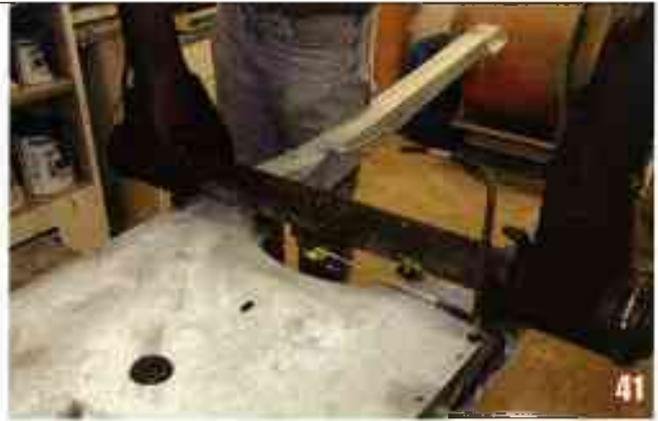
Posez l'essieu arrière en plaçant les ergots dans les trous de centrage des cales d'épaisseur (flèche).
