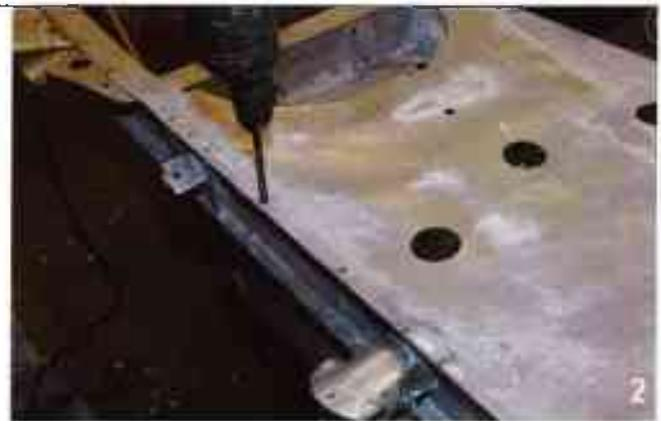
Repercez avec une mèche de 10 mm tous les trous du pourtour du châssis car à galvanisation les aura rétrécis.
