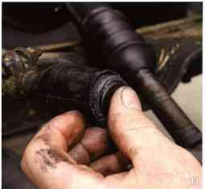
14 Remplacez le second siège et revissez le bouchon, mais pas comme un malade ! Au serrage, quand vous êtes en contact, redevissez de 1/6<sup>e</sup> de tour. La rotule doit tourner assez librement dans l'embout.
