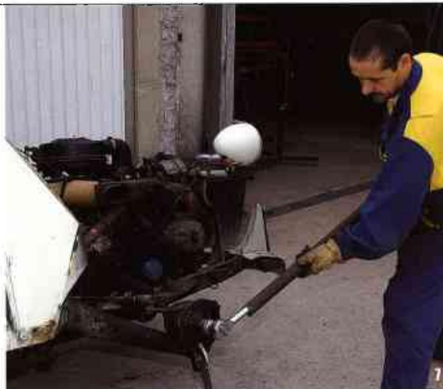
7 Dévissez avec une douille de 32 sur une clé à cliquet très robuste et un long tube pour éviter les efforts inutiles.
