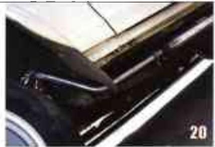
Introduisez le tuyau intermédiaire dans le pot secondaire. Et, au niveau compartiment moteur, vous ajustez ensemble les deux collerettes, celle du tuyau intermédiaire et celle de la bête à cornes. Mettez en place le collier de Ø 47 mm. Serrez à la main.
