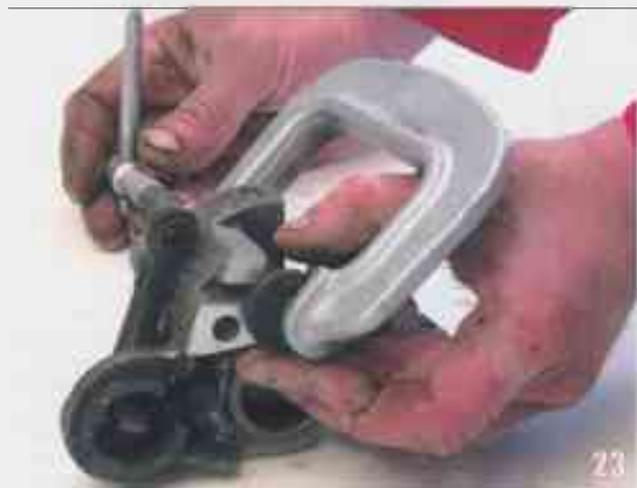
Pour sortir le piston du demi-étrier (côté droit à deux tubes), vous commencez par mettre une plaquette de frein de secours pour obstruer le canal reliant les deux tubes (au serre-joint).
