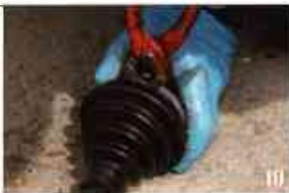
9 Il existe diverses fixations pour les soufflets. Le plus connu et le meilleur est sans doute le Ligarex, mais nous avons préféré ici utiliser le collier livré dans le kit. Il se ferme à la pince. Le fait d'appuyer à la base du collier fait se resserrer les crans jusqu'à étanchéité complète.
