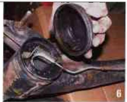
Dégagez le bouchon de moyeu en faisant très attention au tube de frein engagé dans une encoche.
