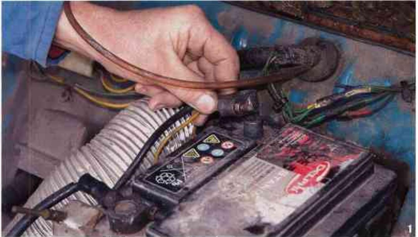
Débranchez la batterie. Pour faciliter l'accès, vous commencez par démonter l'aile gauche (clé de 19) et sa joue d'aile (clé de 8).
