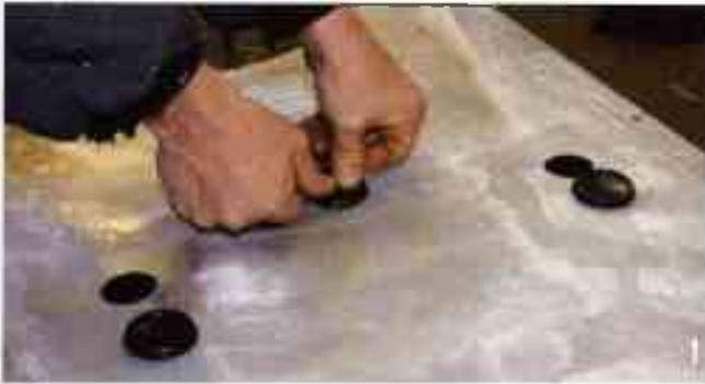
Commencez par poser les bouchons en plastique fournis avec le châssis et qui bouchent les orifices réalisés pour le passage dans le bain de galvanisation. Ces bouchons permettent aussi d'éviter de faire tomber des écrous ou autres vis dans le caisson intérieur, ce qui entraîne des bruits forts désagréables en roulant.
