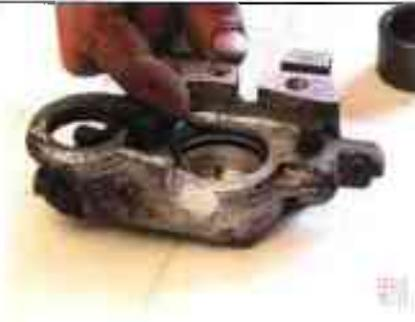
Vous reposez les 2 joints de pistons neufs. Celui qui est de section carrée, se met dans la gorge du fond, il sert à l'étanchéité. L'autre est de section en V (à deux lèvres) et sert de protection pare-poussière. Vous reposez ensuite les joints ronds et tubique dans leurs emplacements respectifs.
