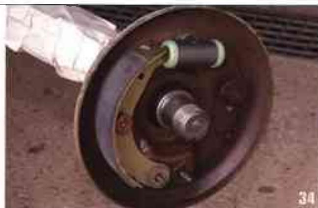
La mâchoire en place, l'écrou du bas n'est pas encore fixé. Fixez la seconde mâchoire.
