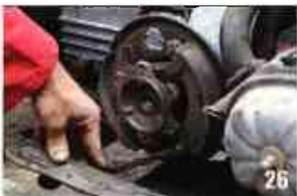
Dévissez l'écrou (généralement il est crénelé) du bas de chaque mâchoire (clé de 11). Certains modèles ont des excentriques réglables en bas, d'autres ont à la place des bagues excentriques sans réglage.
