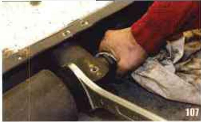
Pschitt. Dévissez le gros écrou intérieur du pot de suspension en maintenant le tube pour que l'ensemble ne tourne pas. Clé de 46.
