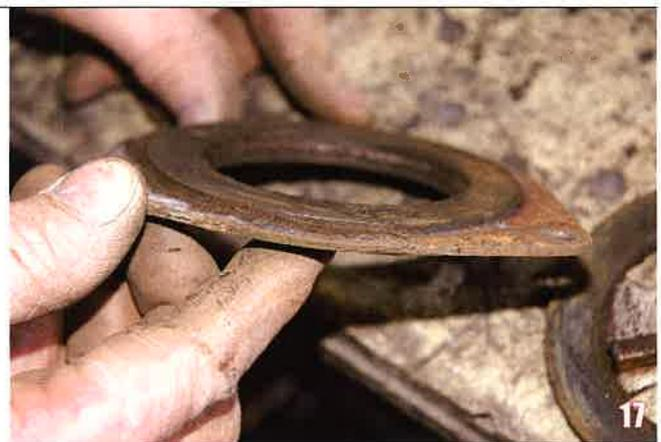
17 Sur la platine de fixation qui se libère quand on retire le frotteur, on voit l'épaisseur du Ferodo, l'usure est flagrante.
