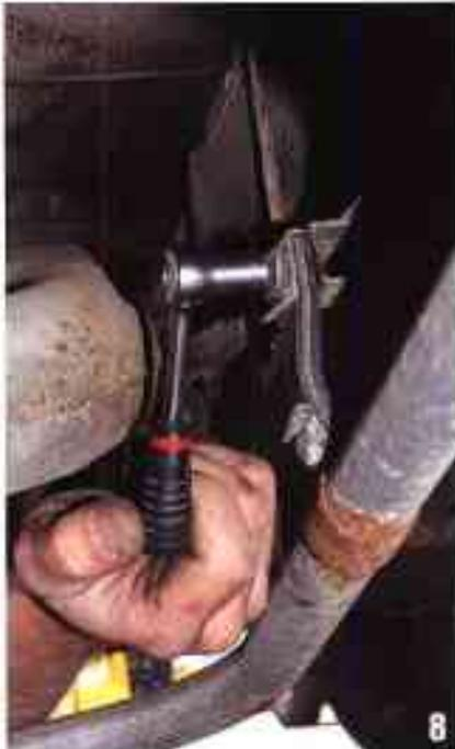
Vous dévissez la 1<sup>re</sup> fixation du tube de sortie, celle qui est sur le châssis. (Cliquet et douille de 11.)
