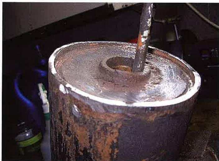
tige pour dégager le tout vers l'extérieur. Il me vient cependant une idée : si vraiment cela ne vient pas, brossez à fond le rebord à l'intérieur et à l'extérieur pour vérifier si un petit malin n'a pas fait, en remontant un jour ce pot, des points de soudure latéraux. Je ne l'ai jamais vu, mais cette procédure non prévue n'est pas impossible, et dans ce cas improbable, il faudrait évidemment percer ces points pour les éliminer. À bientôt !
