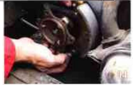
Reposez l'excentrique puis l'écrou (ici un écrou autofreiné sans rondelle). Vérifiez pendant que vous y êtes que le câble de frein à main est bien accroché.
