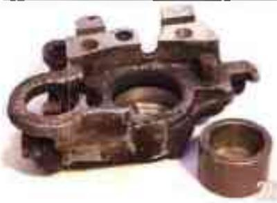
Sur cet exemple, le piston (à droite) est abîmé (marqué), donc à changer, et le logement de piston est oxydé.
