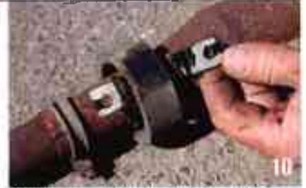
Récupérez les 2 pattes de fixation qui relient l'anneau de suspension silencieuse au plancher sur l'ancienne ligne : une à l'avant du silencieux secondaire et une à l'arrière, plus un pontet en U (voir photo 11). Ces pièces ne sont généralement pas fournies avec l'échappement neuf.
