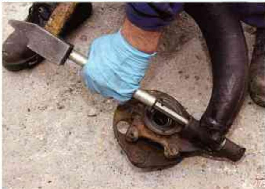
Suiffez l'axe et huilez l'intérieur des bagues inférieure et supérieure du pivot. Enfoncez sur quelques centimètres l'axe de pivot au marteau et au jet. Si cela vous semble bon, vous allez passer sur la presse.
