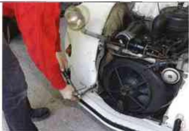
Dévissez les 8 écrous qui tiennent les 2 ailes (clé de 19) : 4 sur la potence de phare et 2 latéraux en bas de la tôle d'auvent, et 2 dans le compartiment moteur.
