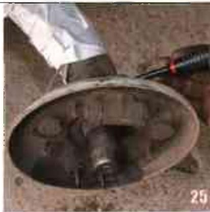
Enlevez les deux vis de maintien du cylindre de roue (clé à cliquet et douille de 10).
