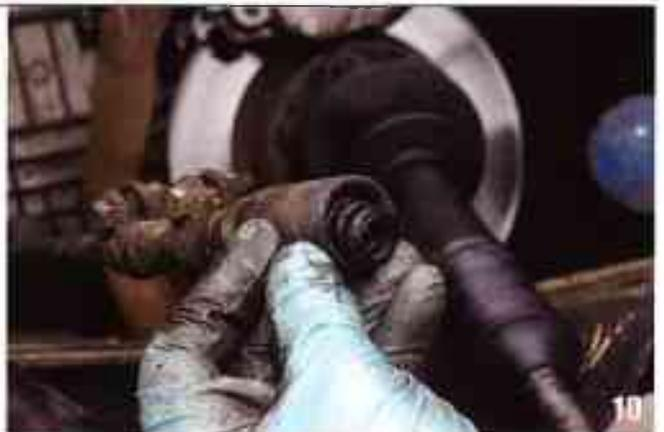
Au tour du ressort maintenant. Nettoyez toutes ces pièces (et l'embout) et regraissez-les copieusement. Vérifiez l'état de la rotule. Pour tout dire, la nôtre est impeccable, aussi on la garde. Si vous constatez une usure importante, changez-la.
