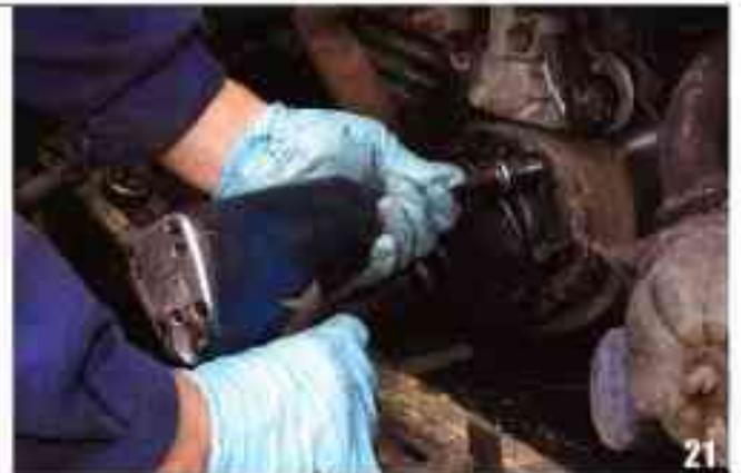
Positionnez le cardan côté boîte de vitesses en le mettant dans ses tétons centreurs, puis vissez les écrous et les vis.
