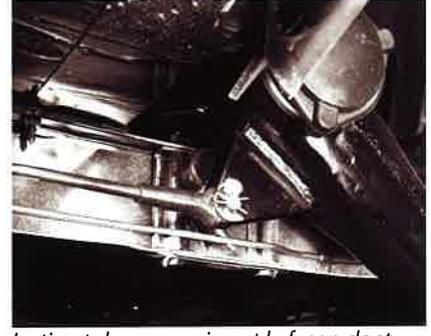
Le tirant de suspension et la façon dont il est attaché au bras.
