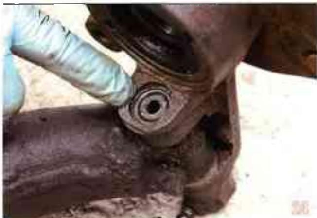
L'axe de pivot doit affleurer la bague en haut du pivot. C'est important ! Sinon vous risquez d'obstruer le graissage, et là...
