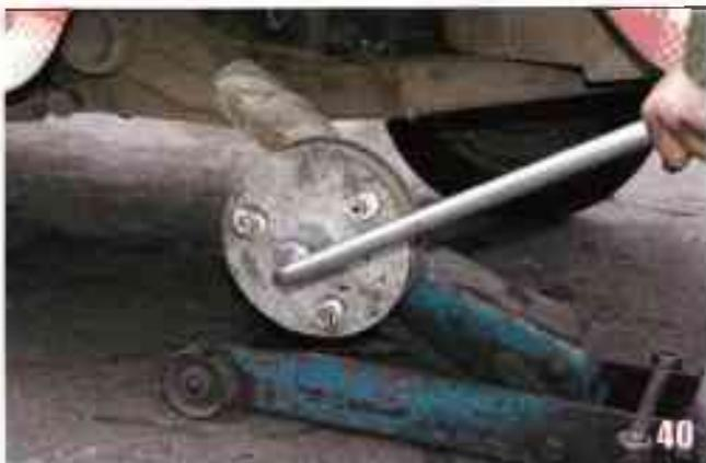
Remontez le plateau "outil-maison" qui nous a servi au démontage. Serrez l'écrou de 32 qui va serrer derrière celui de 44.
