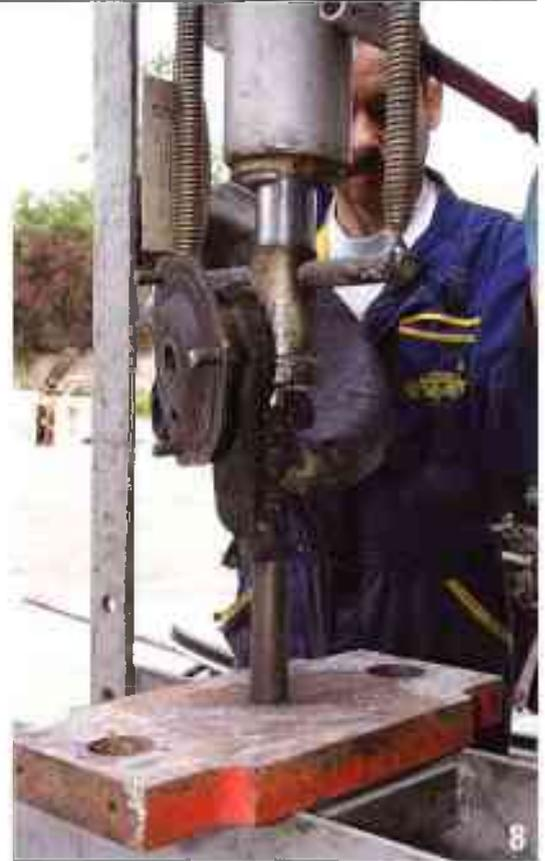
... un tube creux qui permet à l'axe de pivot de descendre et de sortir complètement de son logement à l'aide de l'extracteur 3 (le plus long).
