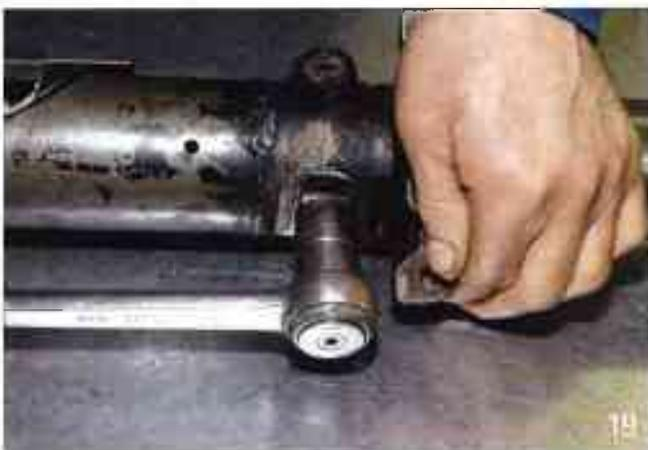
Graissez le guide et introduisez-le dans son logement. Posez le ressort et vissez l'écrou progressivement. Le déplacement de la crémaillère doit se faire sans sentir le passage des dents. Freinez l'écrou si besoin est (les essieux ne sont pas tous troués pour le passage d'une goupille).
