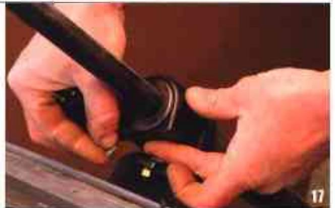
Vous refixez la douille de protection de l'antivol que vous aviez laissée libre sur la colonne avec la petite vis (clé de 7). Ensuite vous rebranchez vos 3 fils repérés et, clé engagée, vous faites les tests de blocage, déblocage et démarrage. Placez le double de la clé en lieu sûr.
