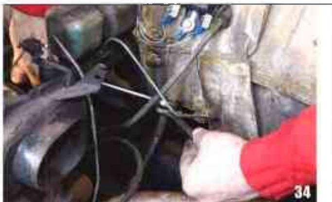
34 Desserrez à l'aide de 2 clés de 16 et 19 (variable selon modèle de câble) le câble d'embrayage. Une fois détendu, on pourra le retirer facilement.
