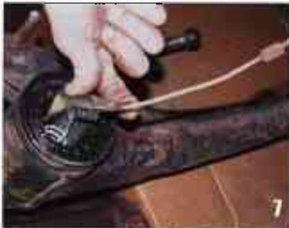
Positionnez le tuyau de frein dans l'axe de l'essieu pour sortir le bras plus facilement. On doit donc détordre le tuyau de frein avec délicatesse.
