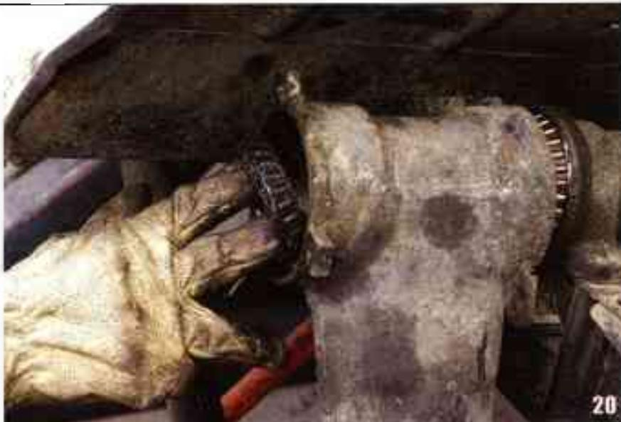
Quand le bras sort, récupérez le roulement extérieur avant qu'il ne tombe à terre. On va en profiter pour tout nettoyer, les deux roulements, celui extrait et celui en place. Si les cages (qui restent sur le bras) sont très marquées, vous changerez le ou les roulements et leurs cages (voir aussi page 68). Au remontage, graissez comme il faut à la graisse graphitée, c'est le mieux.
