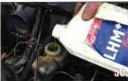
Remplissez le réservoir de LHM. Pompez régulièrement sur la pédale de frein pour évacuer l'air du circuit (vous observerez les bulles d'air remontant dans l'huile). Pompez, pompez petits Shadoks, jusqu'à disparition complète des bulles d'air. La pédale doit devenir plus dure (remettez du liquide de frein si nécessaire). Revisser la vis de purge avant d'enlever la Durit.
