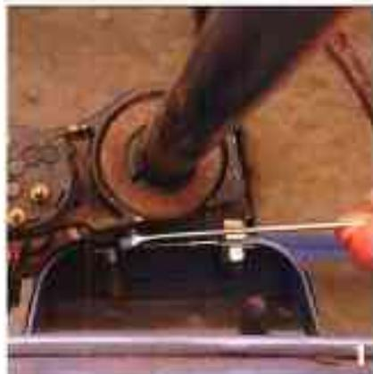
Démontez avec une clé plate de 7 mm la vis de douille de protection de l'antivol.
