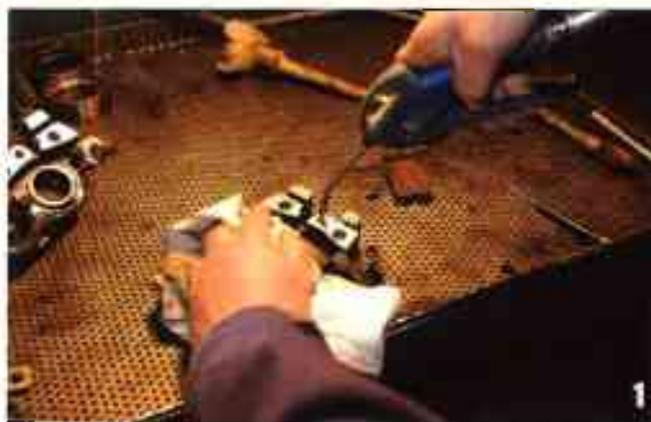
Notre demi-étrier a un piston bloqué. Posez-le sur un étau et faites le test de l'air comprimé pour le sortir ; ça marchera s'il n'est pas coincé. Dans ce cas, cet article ne vous concerne pas (encore), voyez en page 122 et continuez la rénovation de vos freins.
