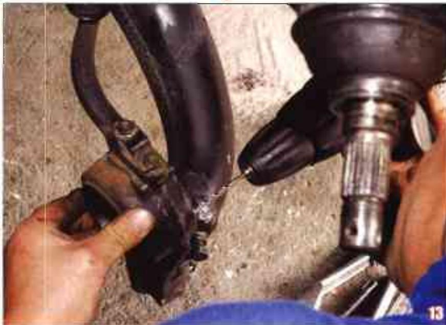
C'est avec une perceuse et une mèche de 4 mm que vous allez démater la bague écrou. Percez légèrement au niveau de chaque coup de pointeau. Ensuite, il va falloir dévisser la bague écrou.
