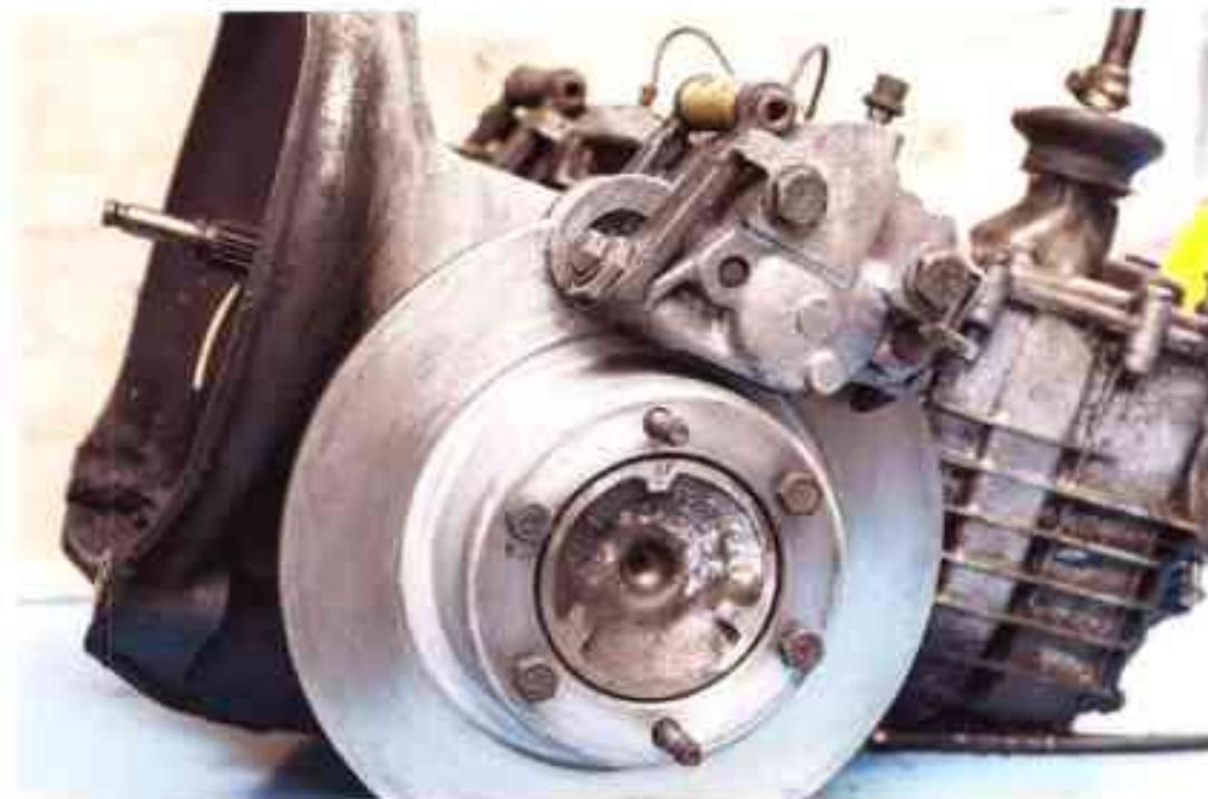
Les freins à disques qui équipent la 2 CV après 1981 sont identiques à ceux que l'on trouve depuis 1969 sur l'Ami 8. Cependant, sur cette dernière, les étriers de freins sont montés dans le sens inverse: le système de frein mécanique (frein de sécurité ou frein à main) est orienté vers le tablier alors qu'il est orienté vers l'avant sur la 2 CV (et sur la Dyane et la Méhari après juillet 1977).
