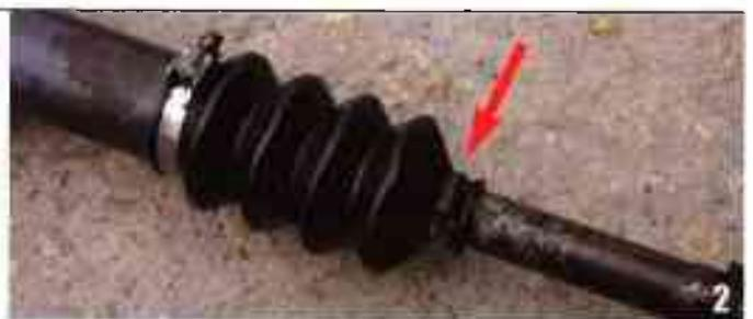
Constat après démontage : voyez le Serflex à droite (flèche), en fait il est inutile car le caoutchouc doit coulisser librement sur le cardan. Donc n'en mettez pas au remontage en croyant bien faire.
