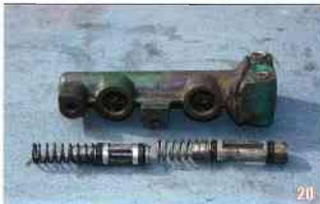
Voici votre maître-cylindre entièrement démonté. Nettoyez toutes les pièces à l'alcool (sans en retirer encore les parties en caoutchouc) et vérifiez bien le corps intérieur du maître-cylindre : il ne doit y avoir aucune trace de piqûres de rouille ou de coups.
