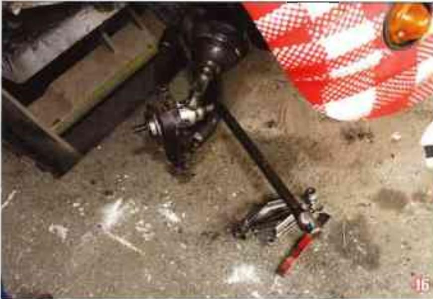
L'outil-maison est en place, l'écrou serré à la main tient bien l'ensemble. Il doit être serré pour être mis en contact mais pas trop pour éviter que de l'autre côté les ergots sortent de la bague écrou. Une rallonge va permettre de dévisser la bague écrou.
