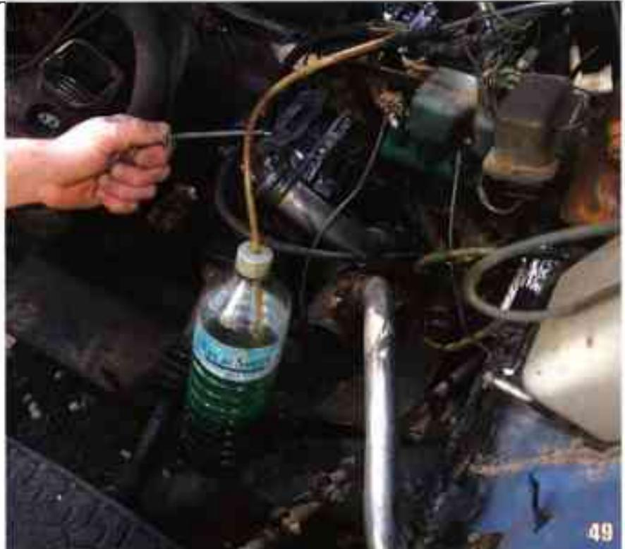
Prenez une bouteille d'eau en plastique et remplissez le fond d'huile (c'est conseillé ou à défaut de LHM à jeter). Percez le bouchon et introduisez une Durit jusqu'au fond dont vous raccorderez l'autre extrémité sur la vis de purge.
