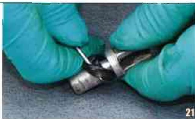
Trempez les caoutchoucs neufs dans du LHM neuf. Ôtez un à un les joints en caoutchouc et remplacez-les au fur et à mesure car ils ne sont pas tous identiques. Aidez-vous d'un petit tournevis pour le démontage et le remontage. Attention au sens de montage et ne les marquez surtout pas avec le tournevis sinon... C'est assez raide à mettre, soyez patient et ayez du soin.
