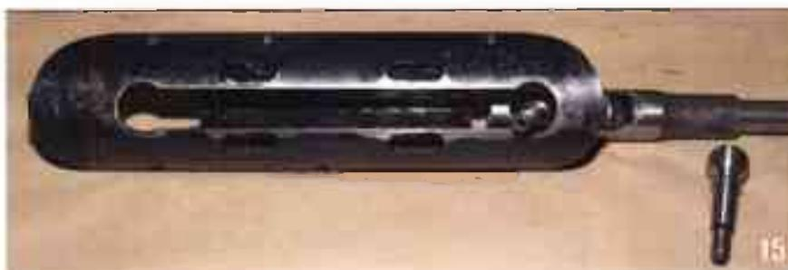
Vous procédez maintenant au remontage. Placez à l'intérieur de la crémaillère (D) l'entretoise (9), le 1<sup>er</sup> siège (8), le 2<sup>e</sup> siège (7), le ressort (5) et l'entretoise (6), le 3<sup>e</sup> siège (4), la rotule (A). Positionnez la crémaillère dans le tube comme sur la photo — attention, les 2 trous (H) sont à l'opposé de la crémaillère. Posez la seconde rotule (B) et le siège (3).
