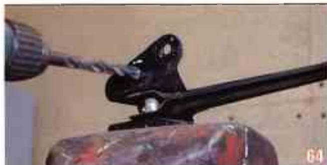
Si les trous de fixation du levier de frein à main ne tombent pas pile-poil dans ceux du châssis, vous devrez les réalésier. Mais ce n'est pas toujours le cas.
