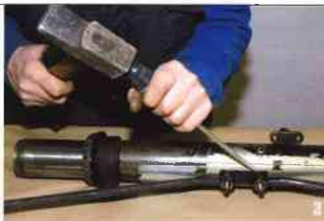
Avec un outil tranchant (ici un tournevis) et un marteau, virez le caoutchouc antibruit qui enserre les deux rotules. Cela va permettre de positionner l'arrache-rotule sans difficulté.
