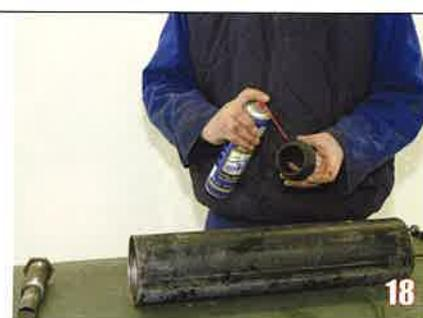
Un coup de bombe aérosol au silicone sur les caoutchoucs des butées.
