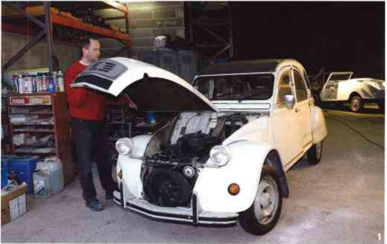
Ôtez le capot en le faisant glisser latéralement. C'est plus facile à deux car ainsi il ne se tortille pas.
