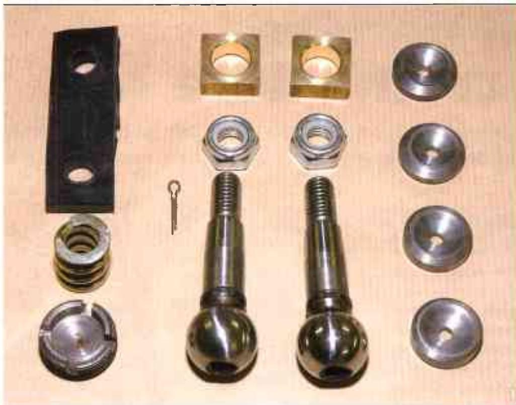
Le kit se compose de deux rotules, de leurs sièges, d'un ressort, d'un bouchon, d'une goupille, d'une protection caoutchouc anti-bruit et pare-poussière, de deux dés et enfin de deux écrous Nylstop.
