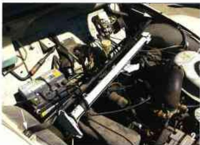
Le compartiment moteur de la Dyane. Sur Dyane uniquement : vous démontez la barre de support de roue de secours avec une clé de 10. Il y a 2 ou 3 vis selon le modèle. Sur 2 CV et Dyane : sortez les gaines de chauffage pour faciliter l'accès.
