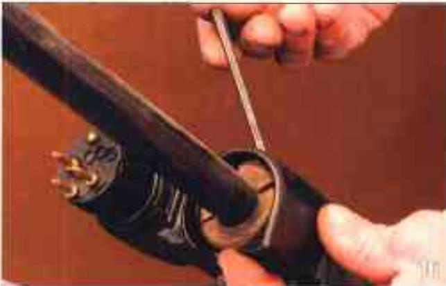
Vous faites glisser les demi-bagues sur la colonne de façon à les repositionner comme sur la photo. Vous serrez alternativement les deux vis de demi-bagues de verrouillage de l'antivol qui emprisonnent le tube (clé alène de 5). Le but est d'obtenir un serrage symétrique. Ici, en cours de serrage, les deux "fentes" ne sont pas encore "identiques".
