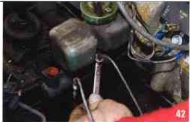
Selon le modèle de maître-cylindre, dévissez le second tuyau de frein avec la même clé à tuyauteur, même opération.
