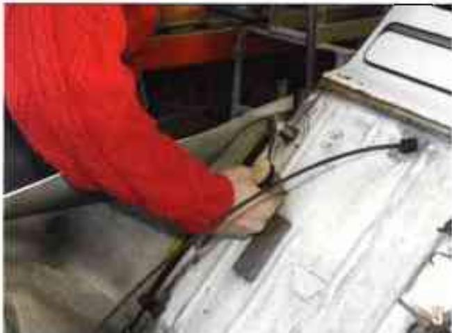
Dévissez les joues d'ailes (clé de 8) : trois vis, une sur l'aile et deux sur le tablier.
