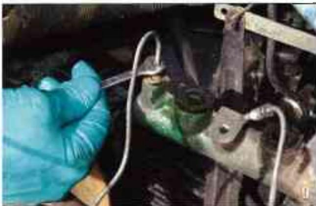
Avec une clé de 8 ou mieux une clé à tuyauter de 8, dévissez les tubes avant et arrière du maître-cylindre. Pour les sortir, tirez les canalisations bien dans leur axe sans les tordre, sinon...
