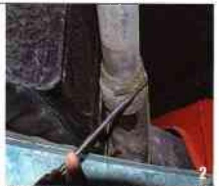
Dévissez le collier qui maintient la Durit au tube de réservoir avec un gros tournevis plat.
