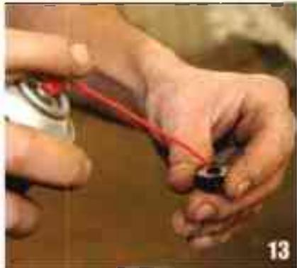
Graissez le passe-fil neuf au téflon en bombe.
