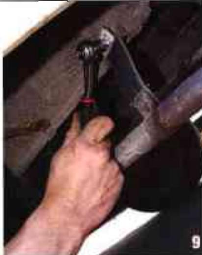
Vous dévissez la 2<sup>e</sup> fixation du tube de sortie, celle qui est sur la caisse (cliquet et douille de 11). Regardez bien comment sont mis les deux supports d'anneau caoutchouc de suspension silencieuse, supérieure et inférieure, car il faudra vous en souvenir pour le remontage. À ce stade, vous sortez la ligne d'échappement complète qui va vous servir de modèle pour assembler la nouvelle.
