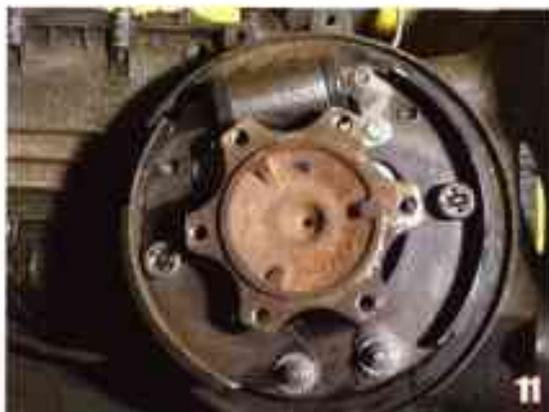
2) - 2CV AZAM 425 cm<sup>3</sup> , 2CV4 435 cm<sup>3</sup> et 2CV6 602 cm<sup>3</sup> diamètre 200 à 6 trous pour cardan homocinétique à billes avec ailettes de refroidissement. (Voir illustration 9).
