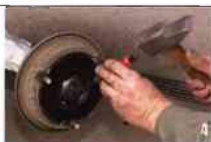
Enlevez le cabochon de moyeu de roue avec un marteau et un tournevis. Le cabochon, s'il est en métal, sera à changer car vous allez le déformer irrémédiablement. Dans le cas d'un cabochon en plastique, si vous êtes prudent, vous pourrez vous en resservir au remontage.
