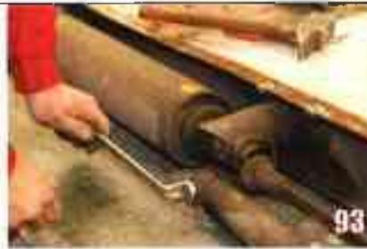
93 Pschitt. Démontez l'écrou arrière de l'amortisseur avant. Clé de 19 (ou 18 selon modèle).
