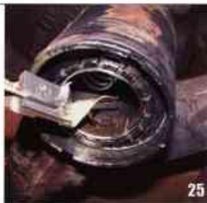
Vous avez vu au démontage que la goupille passe à travers l'essieu dans un trou et le créneau le plus proche de l'écrou à encoches. Vous mettez une goupille neuve d'arrêc d'écrou et vous écartez les deux branches dans l'alésage de la traverse.
