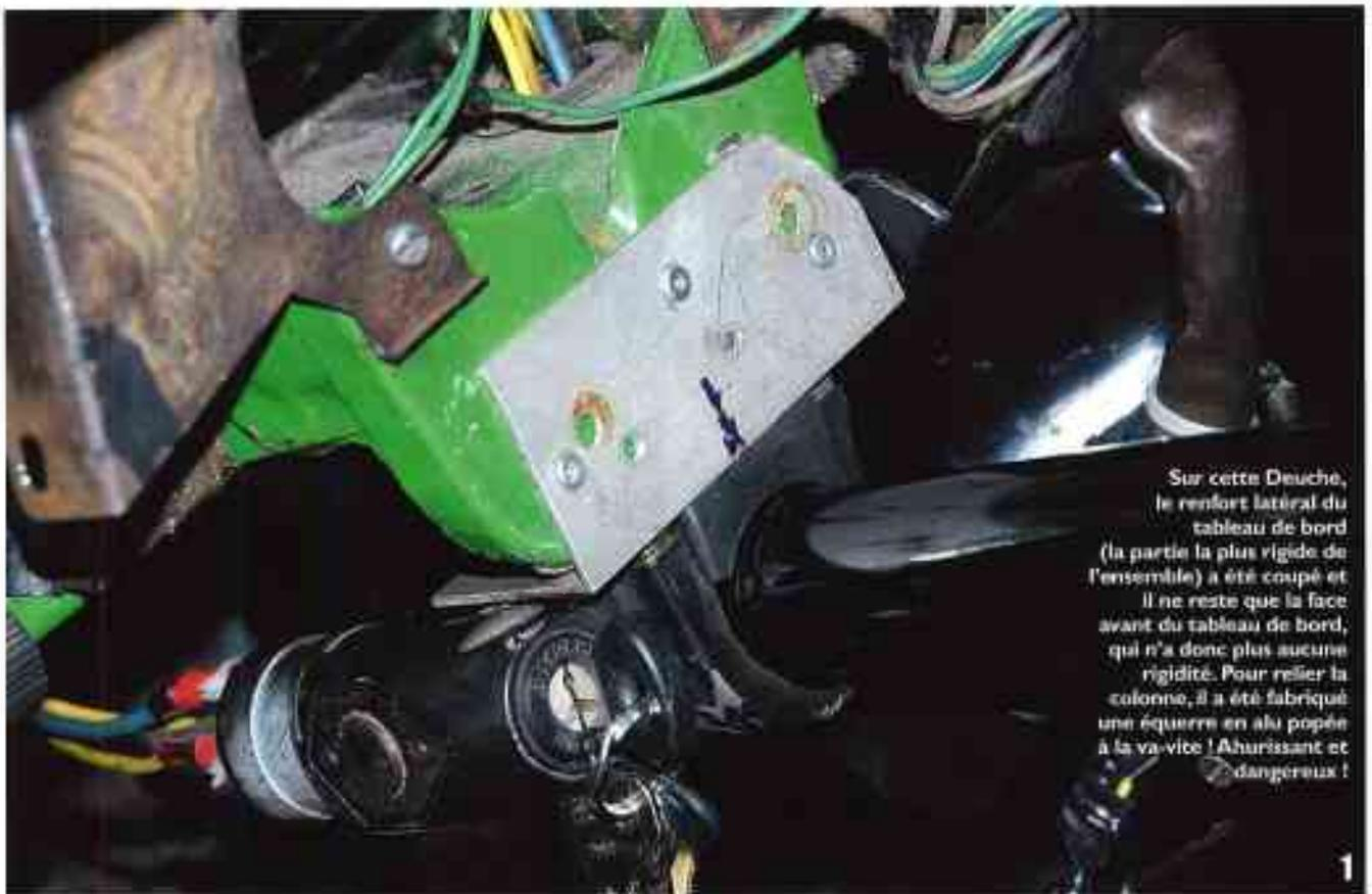
Sur cette Deuche, le renfort latéral du tableau de bord (la partie la plus rigide de l'ensemble) a été coupé et il ne reste que la face avant du tableau de bord, qui n'a donc plus aucune rigidité. Pour relier la colonne, il a été fabriqué une équerre en alu popée à la va-vite ! Ahurissant et dangereux !
