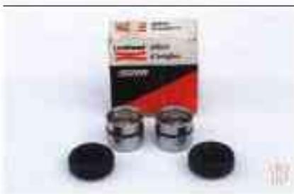
Le kit de réparation pour un cylindre. Il comprend les 2 pistons et leurs caoutchoucs.
