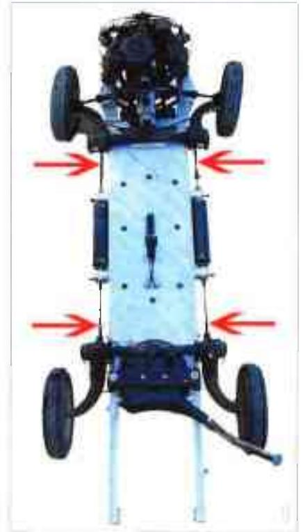
Sur cette photo d'un châssis en cours de remontage, les flèches rouges indiquent les tirants des pots de suspension à l'endroit où le tirant se visse sur son embout.
