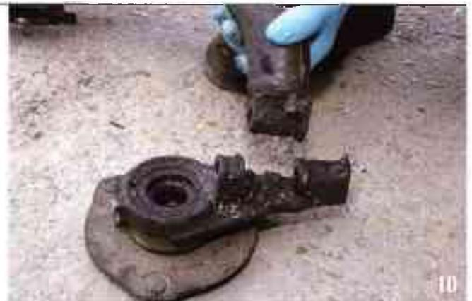
Désaccouplez le bras du pivot en tirant dessus ou au marteau en tapotant s'il vient mal.
