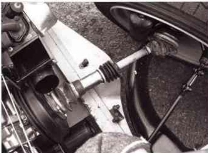
La liaison du tambour à la roue se fait par un arbre à cardan qui encaisse tout le freinage.
