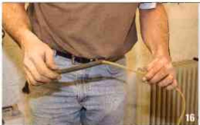
Placez un fourreau de protection caoutchouc de la canalisation d'essence qui ira se positionner au même endroit que sur la photo n° 15. Ne lésinez pas, au point où vous en êtes, et changez le tube de canalisation d'essence et toutes les Durit si besoin est, vous éviterez ainsi bien des pannes futures (prise d'air, fuites...).
