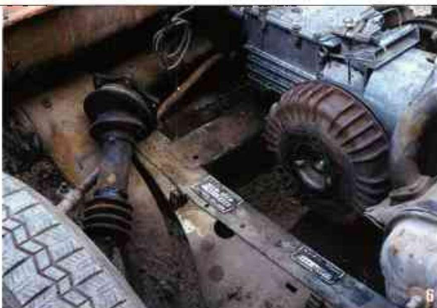
Une fois le cardan de transmission libéré, déplacez-le sur le côté. Pour les modèles à 4 vis, commencez par défaire le graisseur, la coupelle du soufflet et le soufflet avant que le tambour puisse glisser le long de la transmission. Les modèles à cardan simple, quant à eux, sont plus faciles encore : il suffit d'ôter les 4 vis et le tambour glisse sur la transmission. En cas de changement de tambour sur les modèles à 4 vis, il faudra démonter le cardan côté roue et non pas côté tambour.
