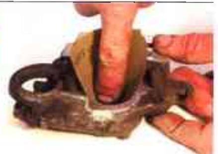
Finissez le nettoyage (seulement en cas d'oxydation) de l'intérieur du corps de piston avec du papier abrasif le plus fin possible (1200).
