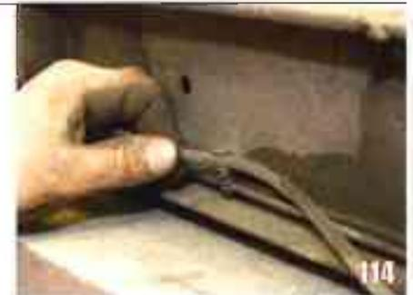
Retirez le tuyau d'essence en le déclipant tout au long du châssis.
