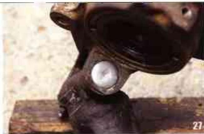
Aplatissez le bouchon expansible au marteau et au jet pour le scerir.
