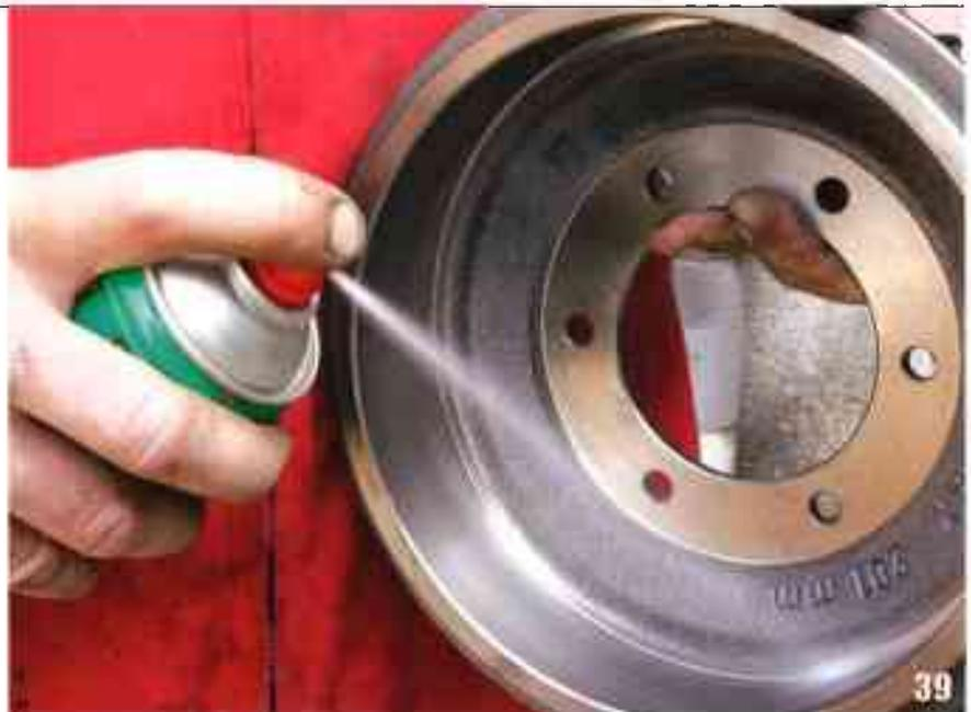
Dégraissiez l'intérieur du tambour avec du nettoyeur frein en bombe. Il ne doit pas être gras, c'est impératif.
