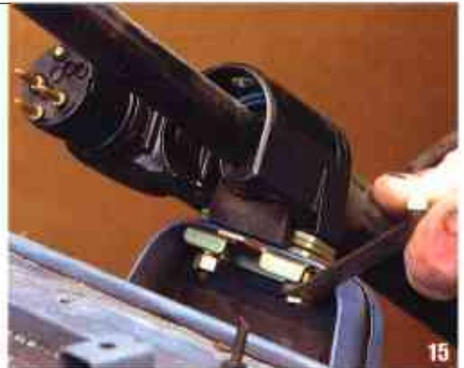
Vous serrez les deux écrous autocassants jusqu'à rupture de la tête d'écrou (clé de 11 mm).
