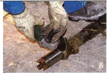
Coupez l'extrémité d'un essieu avant réformé à frotteurs, au niveau du roulement.
