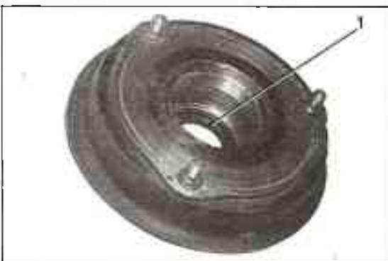
3. Déposer, s'il y a lieu, le roulement et la bague d'étanchéité (1).
