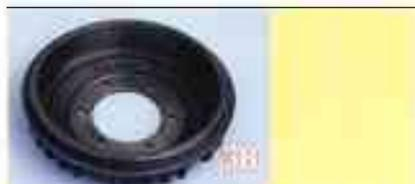
Le tambour neuf est à la cote de 200 mm mais il est indiqué de ne pas dépasser la cote d'usure maximale de 201 mm de Ø.
