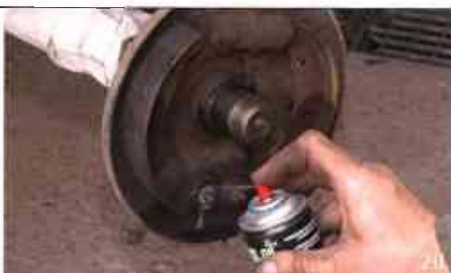
Même après avoir tapoté au marteau, il peut être nécessaire de pschitter un peu de dégrissant pour en venir à bout.
