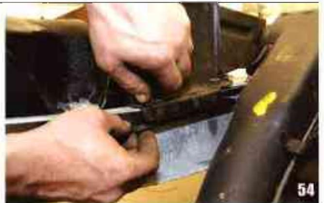
Placez le U, cette pièce qui vient au-dessus du réservoir et qui sert à la fixation des ceintures arrière. Il est maintenu par deux vis de chaque côté, plus un fer plat taraudé. Clé de 14.
