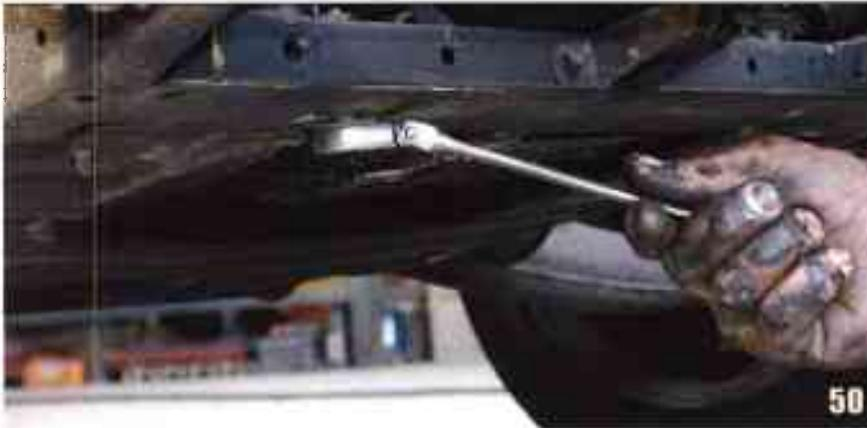
Avec vos mains sales, dévissez les fixations moteur sous la plate-forme. 1 boulon de chaque côté, clé de 17 (ou 16 selon modèle).
