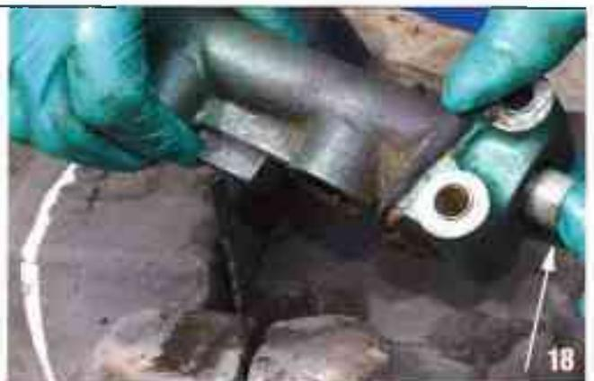
Lors de l'extraction de la seconde entretoise, avec un doigt (flèche), maintenez le piston en bout de maître-cylindre pour éviter qu'il ne s'en aille.
