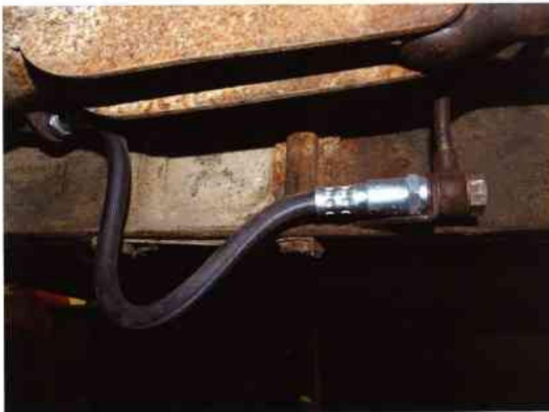
Jusqu'en juin 1970, la 2 CV est équipée de flexibles de freins à l'arrière. Mais attention: il existe deux modèles différents (avant et après juillet 1964). Après juin 1970, le système des flexibles est remplacé par un système en serpentin qui passe dans la traverse d'essieu (voir illustration "nouveau montage").
