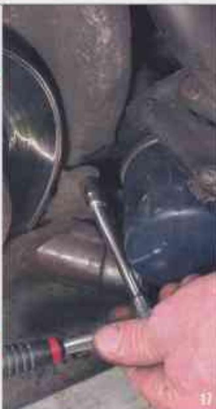
Pour sortir le disque, vous devez dévisser les deux vis de maintien du refroidisseur inférieur qui sont sur le carter de la boîte de vitesses.
