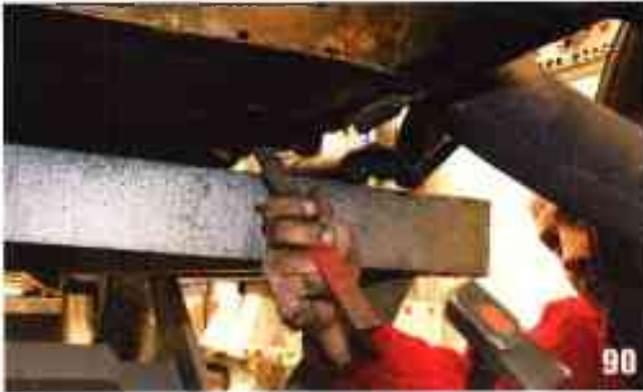
90 A l'aide d'un burin et d'un marteau, repoussez les arrêtoirs de vis de fixation d'essieu avant.
