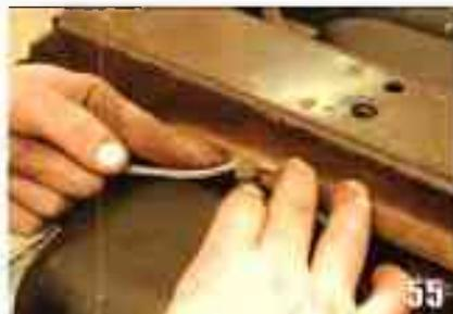
Serrez le câble électrique du + dans la patte fixée le long de l'arrière du U.
