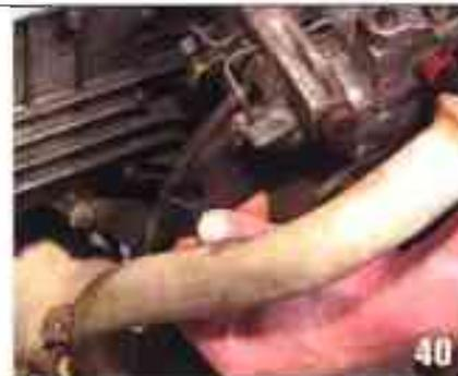
40 Vous installez chaque plaquette neuve par l'arrière de l'étrier, Ferodo vers le disque et comme le montre la photo en la glissant vers l'avant. Ensuite, vous la remontez pour la verrouiller. L'encoche de la queue de la plaquette devient prisonnière du ressort double.
