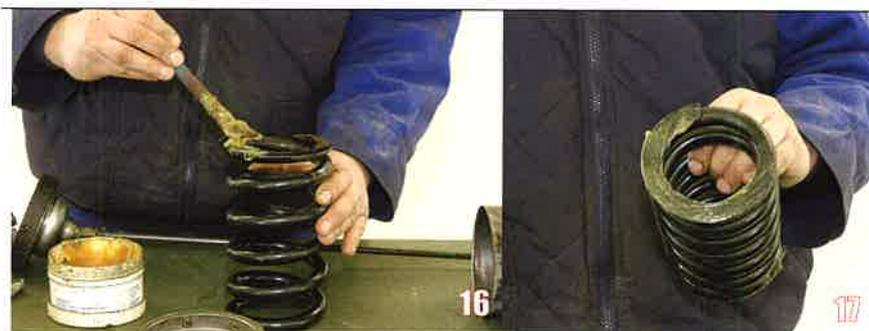
Graissez les deux faces des ressorts à la graisse marine.
