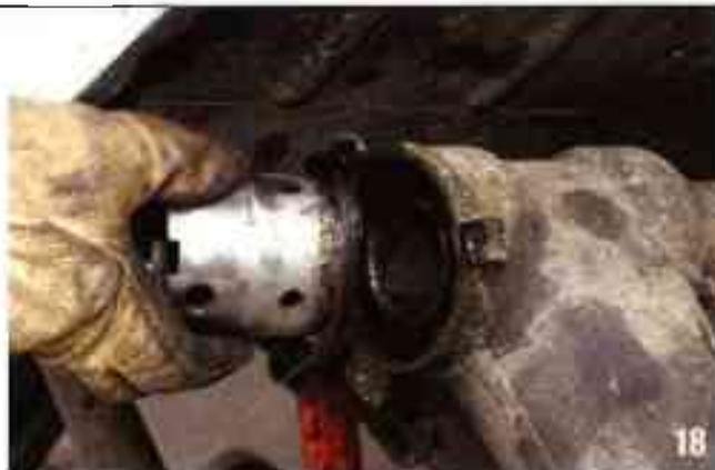
Sortez l'écrou crénelé sur lequel est collé par la graisse le joint pare-poussière. Nettoyez le tout avec un dégraissant quelconque.
