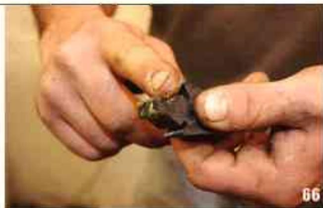
Graissez les caoutchoucs antibruit d'ailes avant (mieux, comme nous, mettez-en des neufs). La graisse permet de les enfiler plus facilement.
