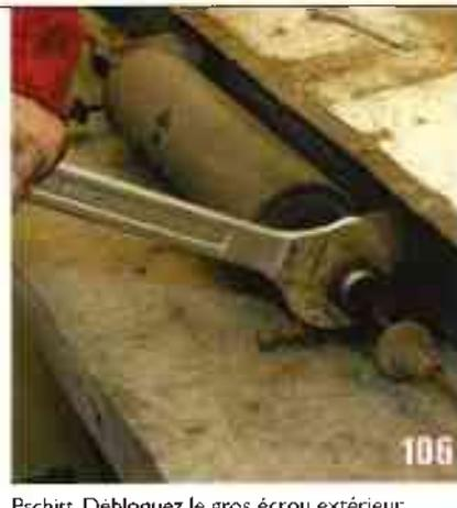
Pschitt. Débloquez le gros écrou extérieur du pot de suspension. Clé de 46.
