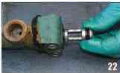
Enduisez bien le corps intérieur du maître-cylindre avec du LHM neuf. Introduisez le premier piston le plus court des deux avec le ressort le plus long. Positionnez le piston comme sur la photo car l'entretoise vient se placer dans la fente pour stopper le débattement du piston lors du freinage.
