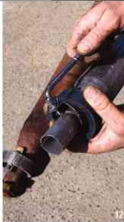
Vous prenez en sandwich entre la patte soudée et la bride d'anneau de suspension silencieuse à l'avant du silencieux secondaire (la bride d'anneau se bloque dans un logement d'un côté et est vissée de l'autre, vous ne pouvez pas vous tromper au remontage). Vous répétez l'opération à l'arrière (clé de 8 à pipe). N'oubliez pas la rondelle.
