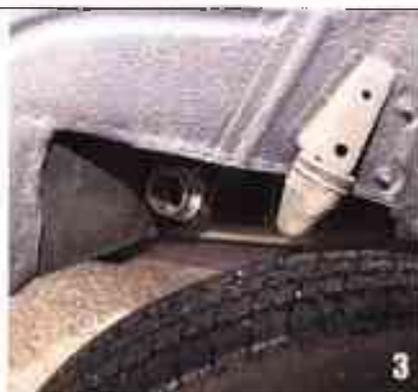
Voici ce qui reste sous l'aile : le caoutchouc entre réservoir et goulotte.
