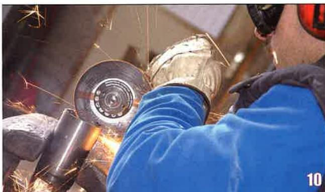
Tronçonnez l'autre extrémité du bout d'essieu pour obtenir un plat qui permettra de le coincer dans l'étau.
