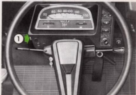
Fig. 19 bis - 1 - Commande du signal de détresse
