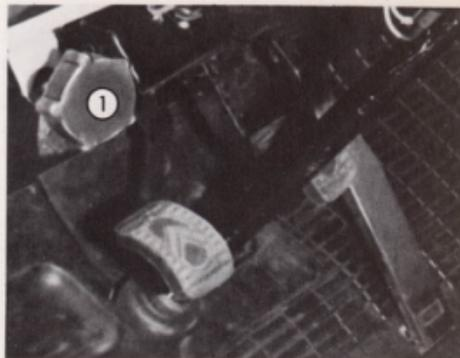
Fig. 39 - Réglage des projecteurs en roulant
