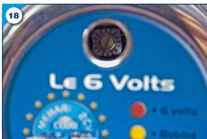
**5.** Avant la pose de l'allumage électronique, procédez à l'initialisation de celui-ci. Déposez l'écrou de protection (photo 15) afin d'accéder au potentiomètre de réglage (photo 16). Pour un moteur de type A375 placez le curseur en position 1 (photos 17 et 18). Remontez la vis de protection (image 19). Si vous disposez d'un autre type moteur, référez-vous au tableau en dernière page.
