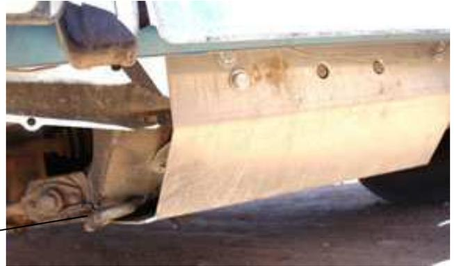
L'anneau est soudé au châssis : conforme
