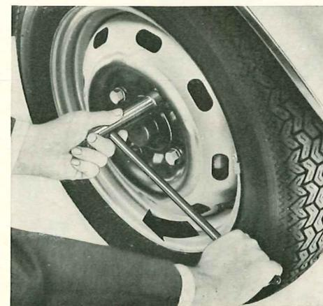
Le serrage des boulons/écrous peut être obtenu sans difficultés par une personne de force normale utilisant correctement l'outillage de bord. En cas de doute, après le changement d'une roue, faites contrôler à la première occasion le serrage des boulons avec une clé dynamométrique.
