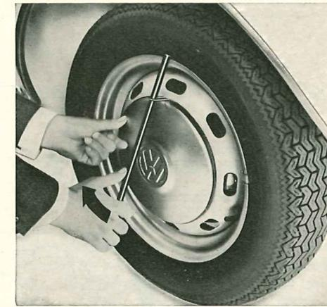
Desserrez d'un tour environ tous les boulons — écrous sur le **type 2** — de fixation de la roue avec la clé à tube que vous faites tourner au moyen de la tringle.
