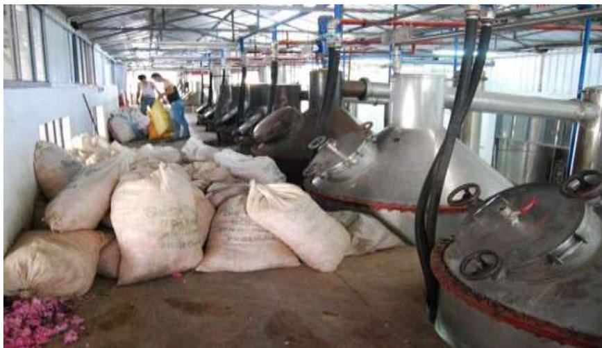
Figure 8: Distillation de Rose de Damas pour laquelle plusieurs tonnes de pétales sont nécessaires pour obtenir un kilogramme d'huile essentielle (Source : Bousquet E, Mai 2014)
